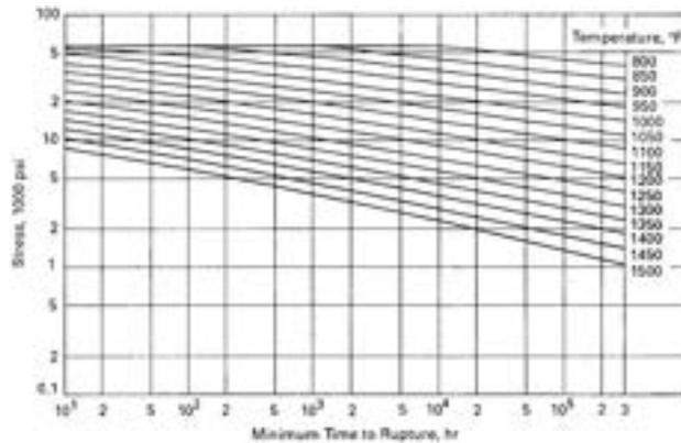
**Figura 6.1:** Sollecitazione minima a rottura per acciaio inossidabile tipo 304
