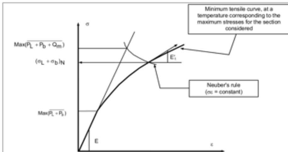
Figura 5.5: Determinazione grafica di  $(\sigma_L + \sigma_b)_N$  e di  $E'_t$
