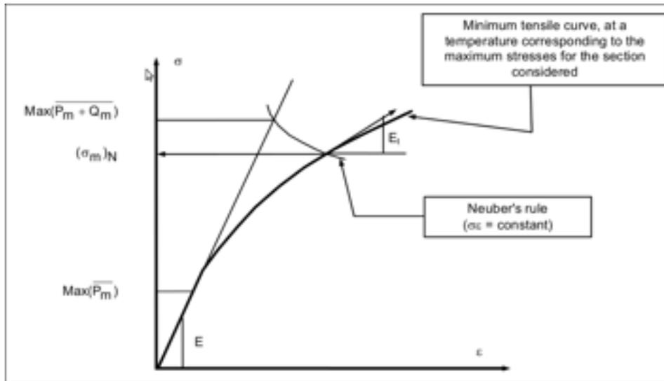
Figura 5.11: Determinazione grafica di  $(\sigma_m)_N$  e di  $E_t$
