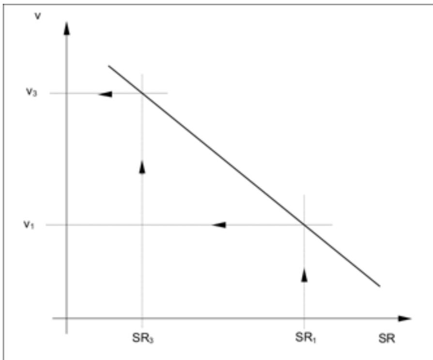
**Figura 7.1:** Determinazione dell'*efficiency index*
