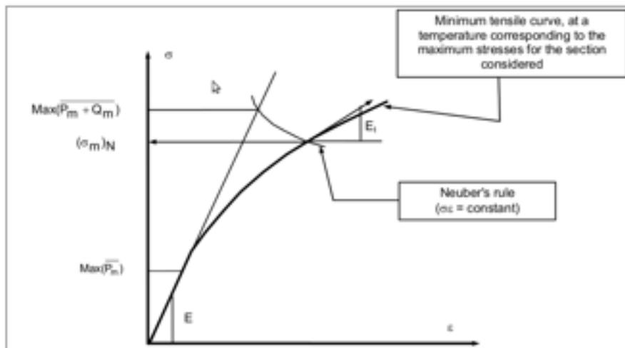
Figura 5.4: Determinazione grafica di  $(\sigma_m)_N$  e di  $E_t$
