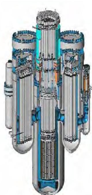
Figura 11: Schema del reattore VBER [9]
