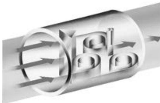
**Figura 18: Principio di funzionamento del misuratore vortex**
