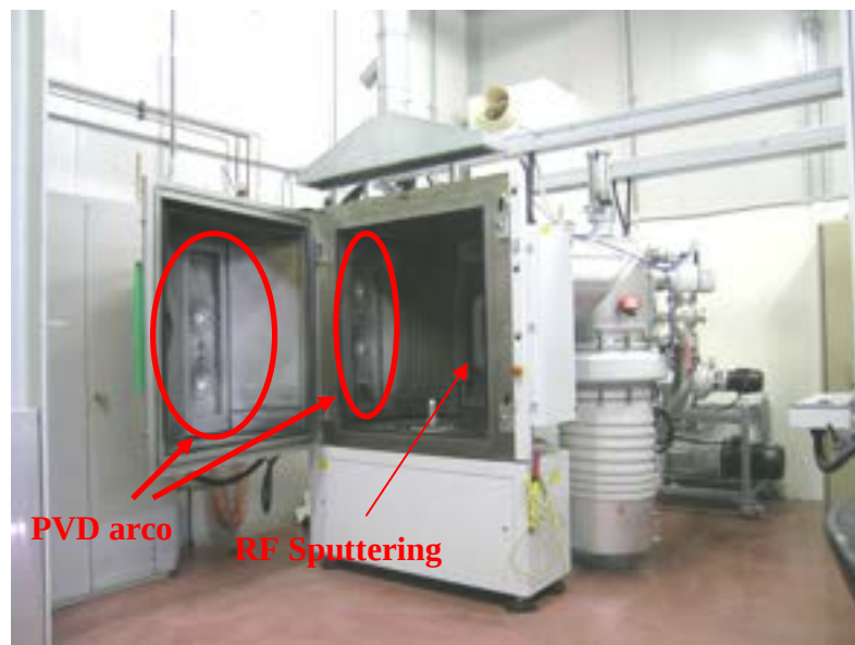
Figura 2. 9 - Disposizione delle sorgenti all'interno della camera di deposizione
