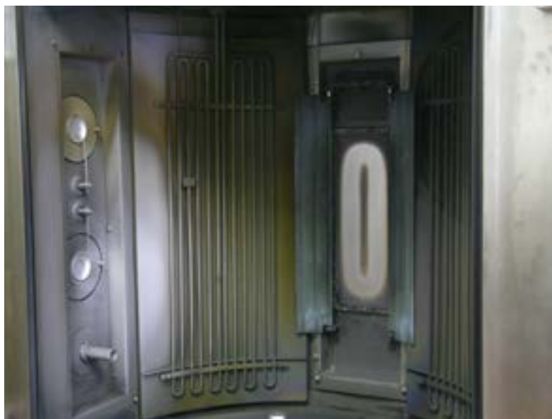
Figura 2. 10 – Sorgenti ad arco, riscaldatore e target RF- sputtering
