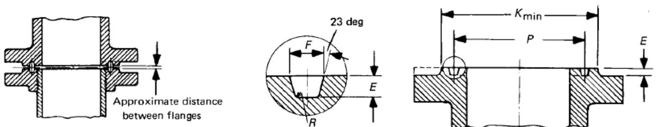
**Figura 7:** dimensionamento flange RJT (NPS 1" – classe 2500), ASME B16.5
