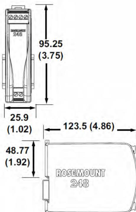
**Figura 11:** trasmettitore 248R Railmount: dimensioni in mm (inch)
