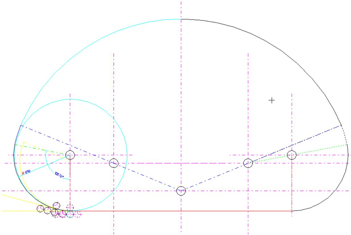
A titolo di esempio vengono riportate nel seguito le considerazioni necessarie per la sagomatura corretta del conduttore che tiene conto del ritorno elastico dello stesso.
