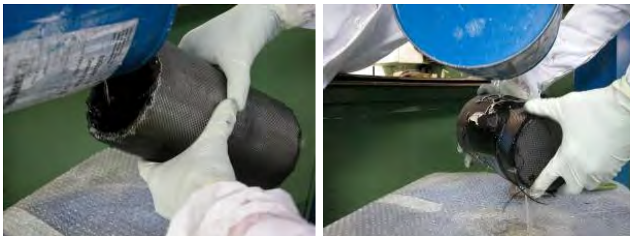
Figura 21 – Impregnazione del crogiolo prima del trattamento termico
