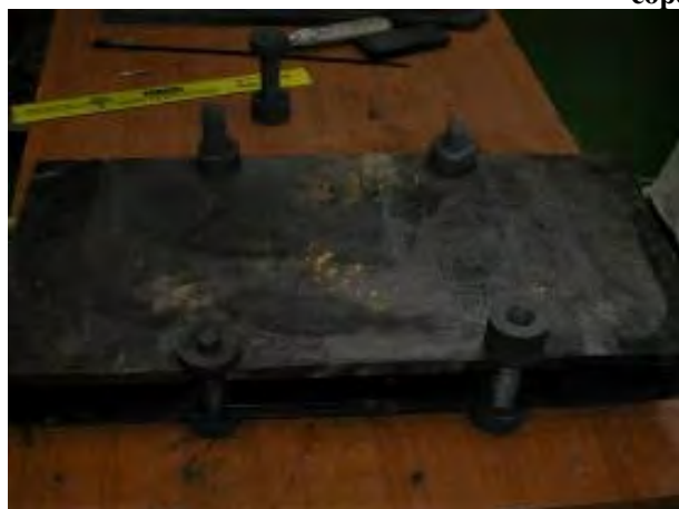
Figura 18 – Particolari della chiusura dello stampo
