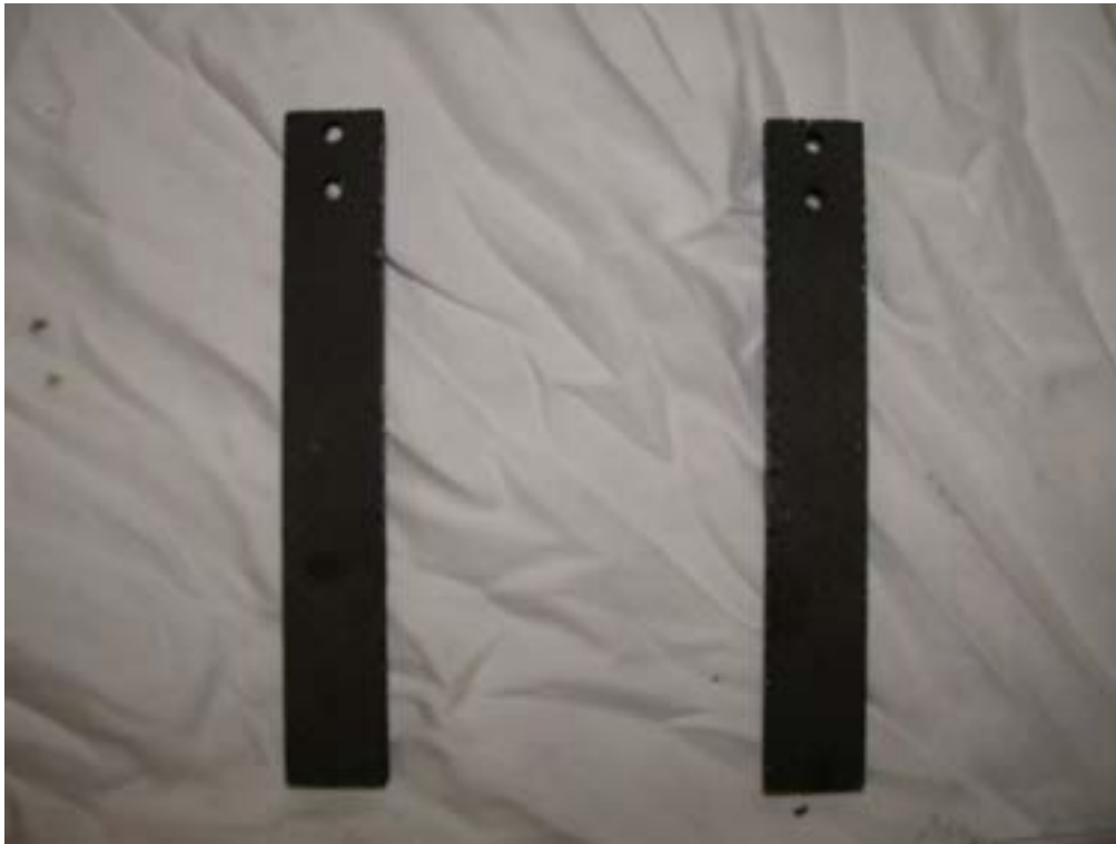
Fig.5 Provini in SiC/SiC per la prova in Pb17Li
