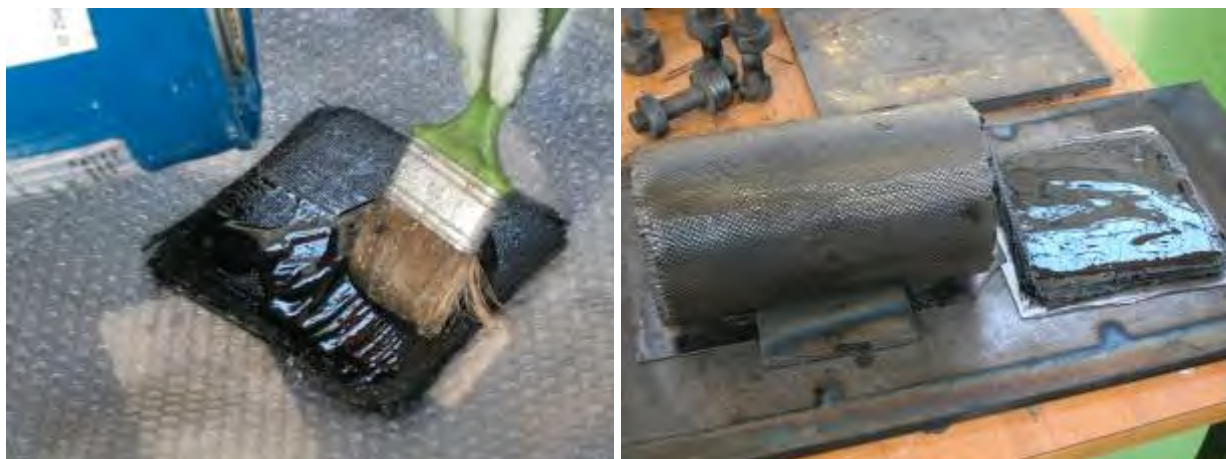
Figura 21 – Impregnazione del crogiolo prima del trattamento termico
