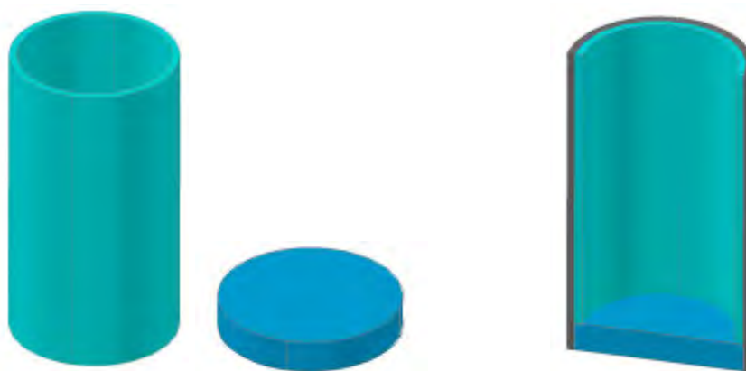
Figura 20 – Schema di assemblaggio del crogiolo
