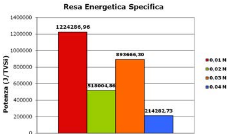
Figura 58 – Resa energetica specifica globale ottenuta al variare delle caratteristiche della soluzione anodica (sistema B-E-I)
