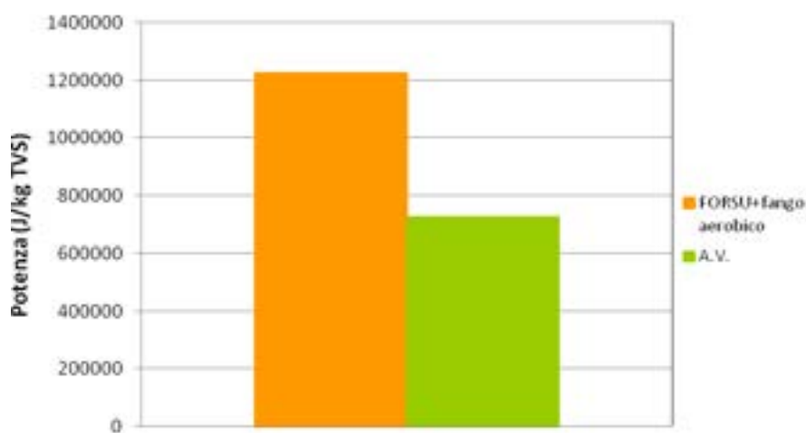
Figura 67 – Confronto tra le rese energetiche specifiche (prove batch di B-E-I su miscele FORSU + AV e FORSU + fango)
