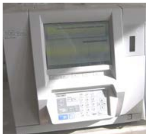
Figura 12 – Modulo TOC-V CSN per la determinazione del TOC su campioni solidi
