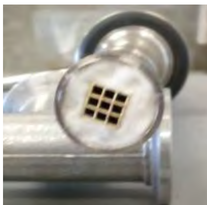
Fig. 14: Monolite caricato nel reattore
