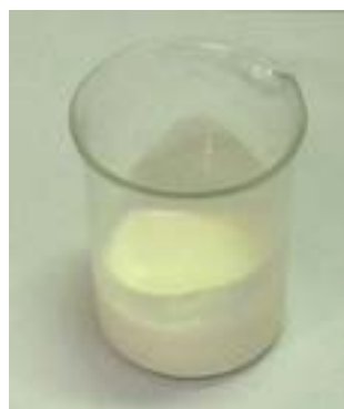
Fig. 7 : Washcoat diluito utilizzato per l'impregnazione.
