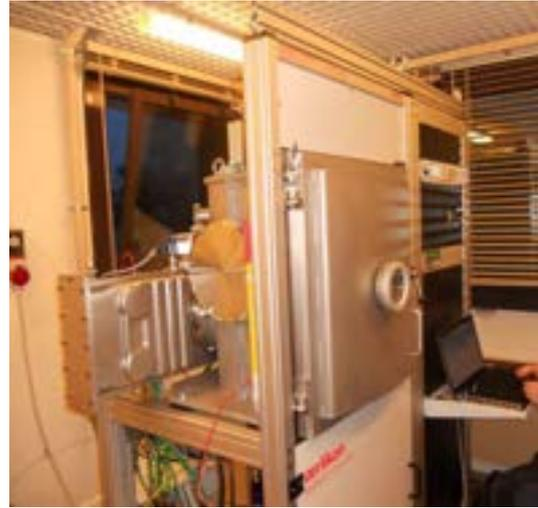
Figura 8. Foto dell'impianto di sputtering Oerlikon Leybold Univex 450B installato nei laboratori del C.R. Casaccia dell'ENEA.
