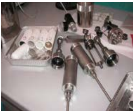
Fig 9 -Sistema di campionamento: pompa di aspirazione (a), filtro e porta filtro (b,c, d)
