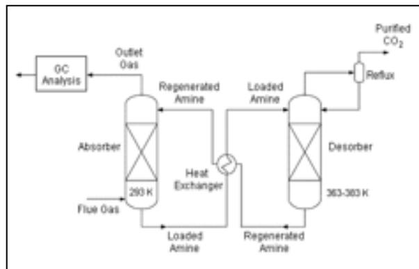
**Figura 1-** Diagramma di flusso, semplificato, della configurazione ciclica di assorbimento e di desorbimento-rigenerazione.
