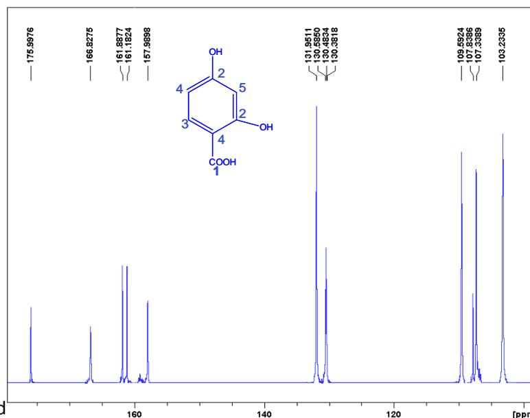
**Figura 10-** Spettro NMR d'assorbimento di CO<sub>2</sub>. Assegnamenti dell'acido resorcilico ( $\delta$ , ppm): 176.0, C(1); 166.8, 161.9, C(2); 131.9, C(3); 109.6, 107.8, C(4); 103.2, C(5).
