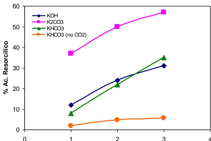
**Figura 9-** Confronto delle percentuali dell'acido β-resorcilico con rapporto base/resorcina 1.5/1 in funzione della base, del tempo di reazione (1-3 h) ed in assenza di CO<sub>2</sub>.
