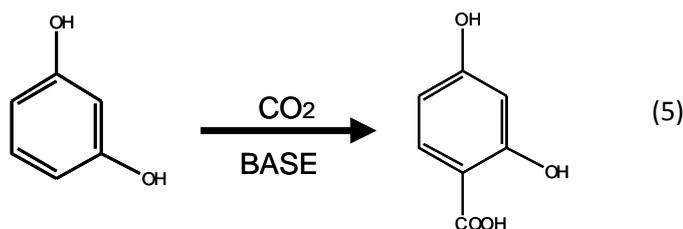
E' stata studiata la capacità di assorbimento di CO<sub>2</sub> in soluzioni acquose di resorcinolo impiegando condizioni sperimentali differenti per la sostanza basica usata, KOH, K<sub>2</sub>CO<sub>3</sub>, KHCO<sub>3</sub>, per i rapporti base/resorcinolo, 1/1; 1.5/1 e 2/1 e per i tempi di reazione compresi fra 1 e 3 ore. Gli esperimenti sono stati
