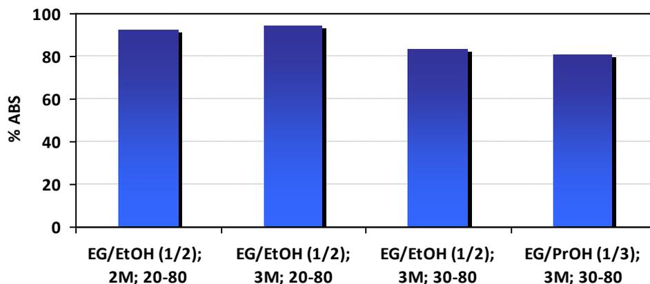
**Figura 5-** Variazione dell'efficienza di assorbimento in funzione della concentrazione di AMP e della miscela alcolica.
