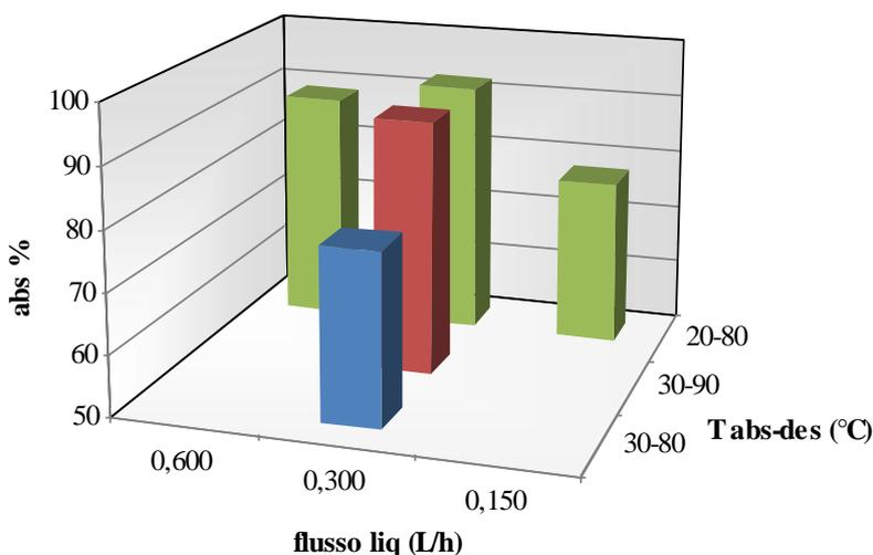
**Figura 4-** Variazione dell'efficienza di assorbimento di CO<sub>2</sub> della miscela AMP/EG/EtOH in funzione delle temperature di assorbimento/desorbimento e del flusso del liquido
