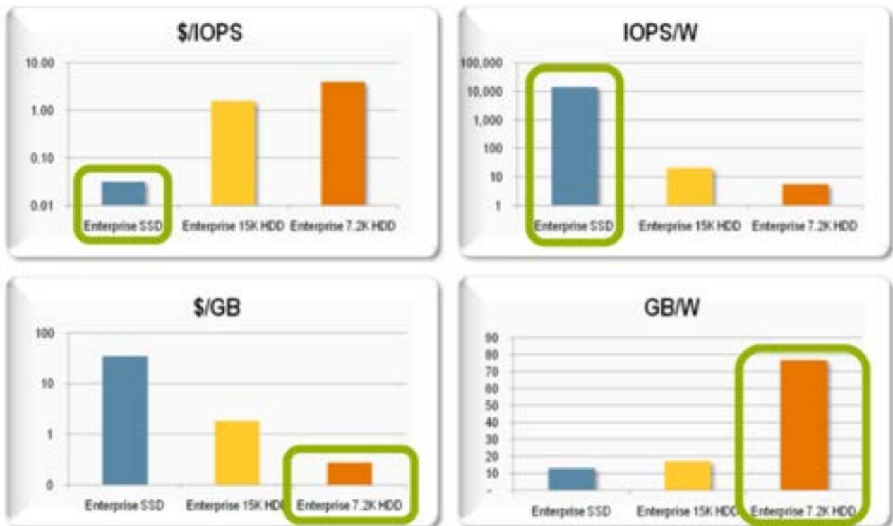
Figura 3: Confronto IOP/Watt SSD e HDD a 15.000 rpm e 7.200 rpm<sup>4</sup>
