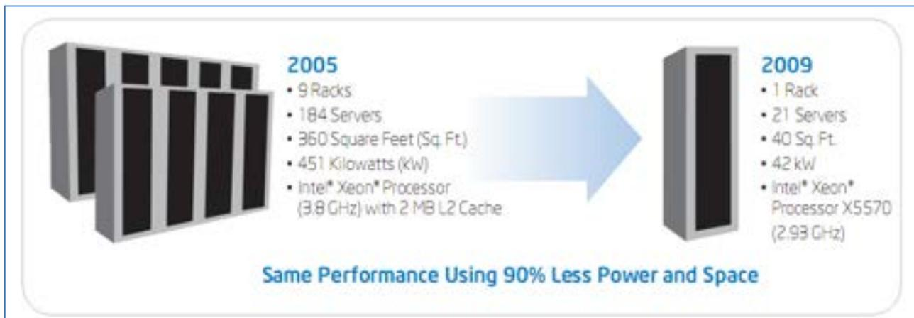
**Figura 5: Un esempio di consolidamento di server del 2005 con un server del 2009<sup>6</sup>**
