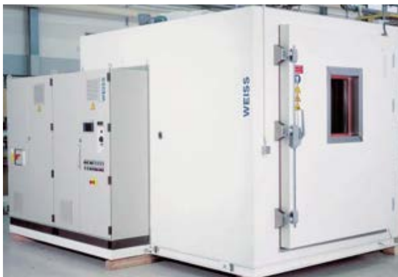
Figura 2. A sinistra: esempio di camera climatica walk-in . A destra: la camera climatica di dimensioni ridotte.
