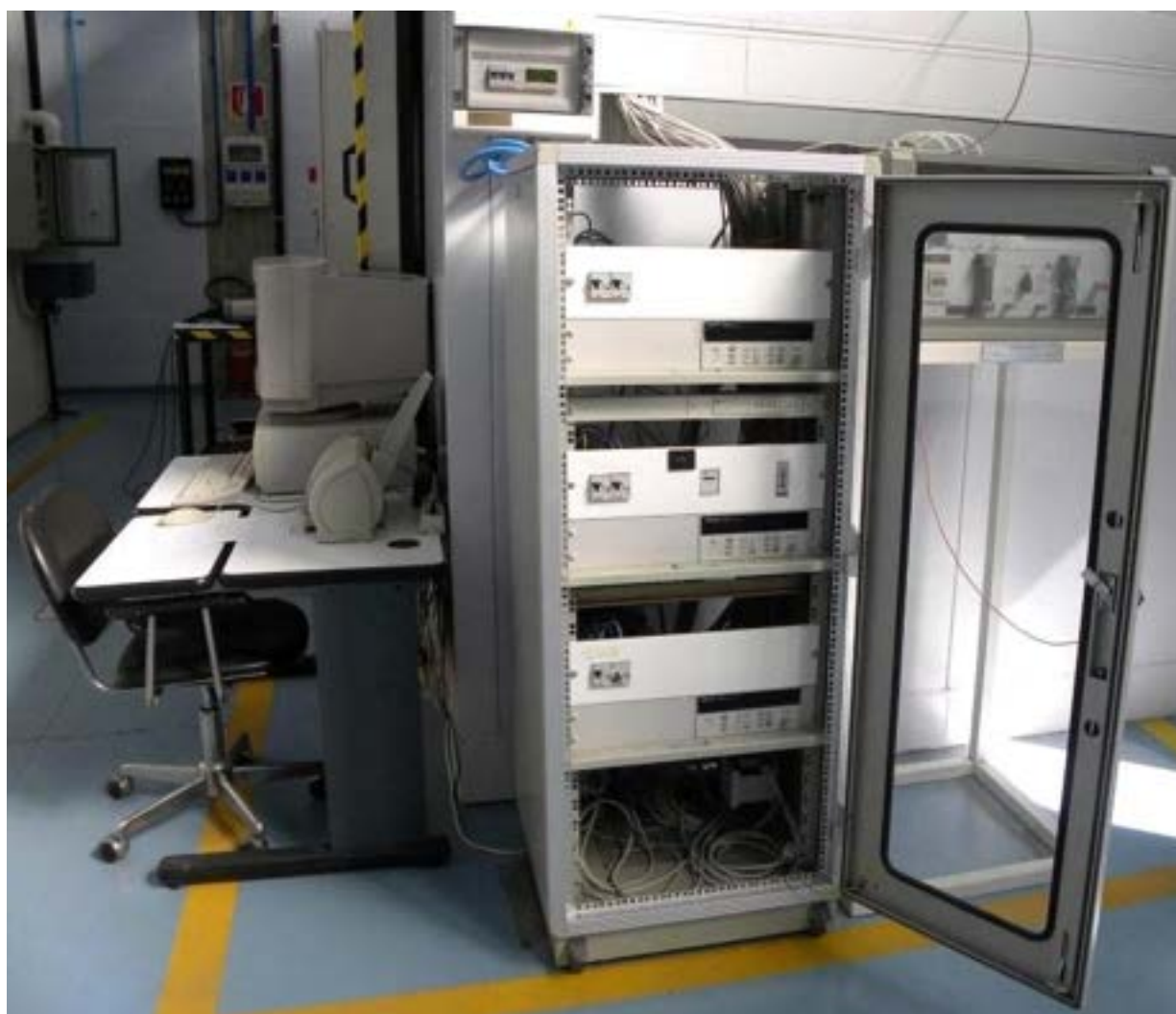
Figura 12: Particolari del sistema di acquisizione dati. In alto a sinistra: calibratore e multimetro per taratura. In alto a destra: acquisitore. In basso: il sistema di acquisizione completo della camera climatica.
