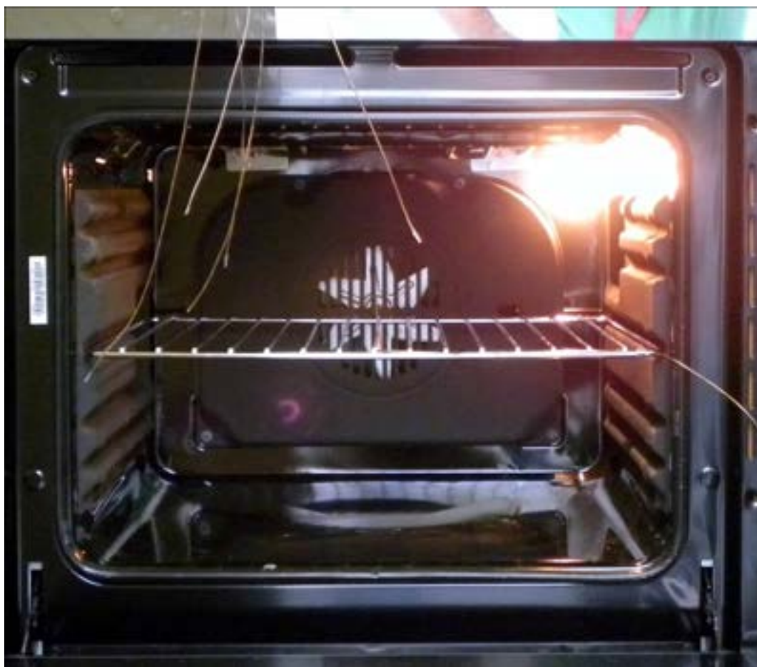
Figura 7: Preparazione di una prova sui forni elettrici: disposizione delle termocoppie
