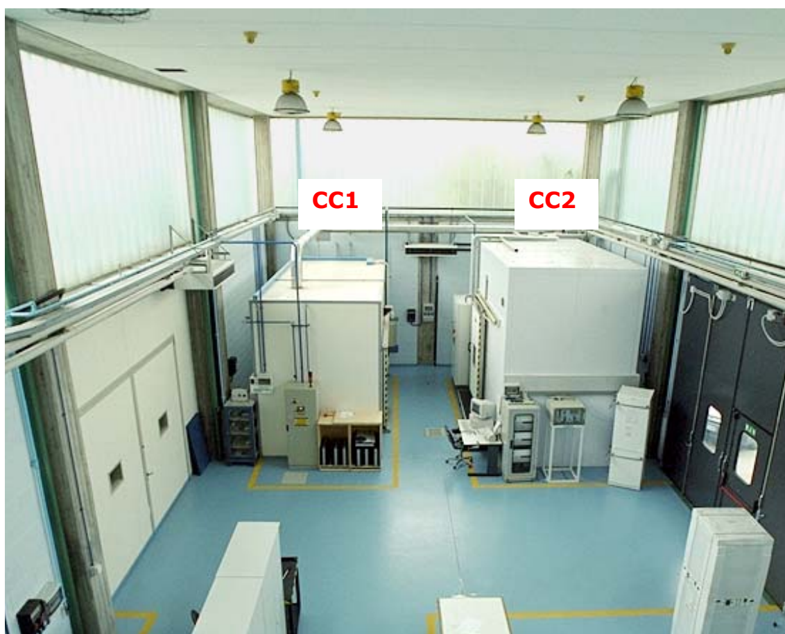
Figura 1: Laboratorio di prove visto dall'alto con le due camere climatiche (qui indicate con CC1 e CC2).
