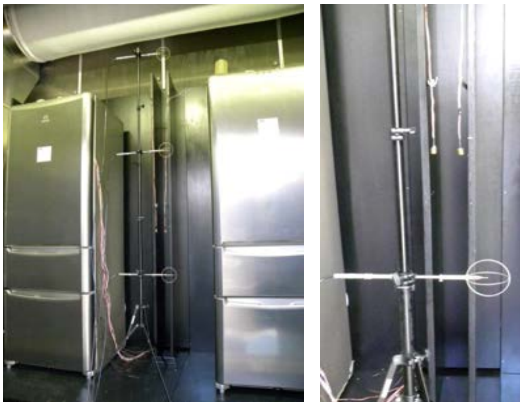
Figura 5: Misura della velocità dell'aria (anemometro) e temperatura nella camera climatica
