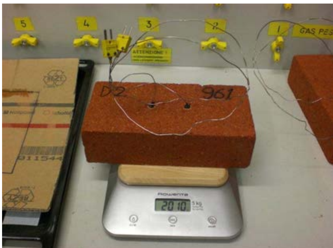
Figura 6. In alto: Connessione elettrica del mattone usato per la prova di carico (descritta nelle sezioni successive) all'interno del forno elettrico. In basso: Pesatura del mattone usato per la prova di carico.
