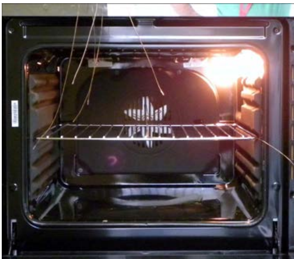
Figura 5. In alto: Connessione elettrica in camera climatica. In basso: Interno di forno elettrico. Particolare dell'inserimento di termocoppie prima di misure prestazionali.
