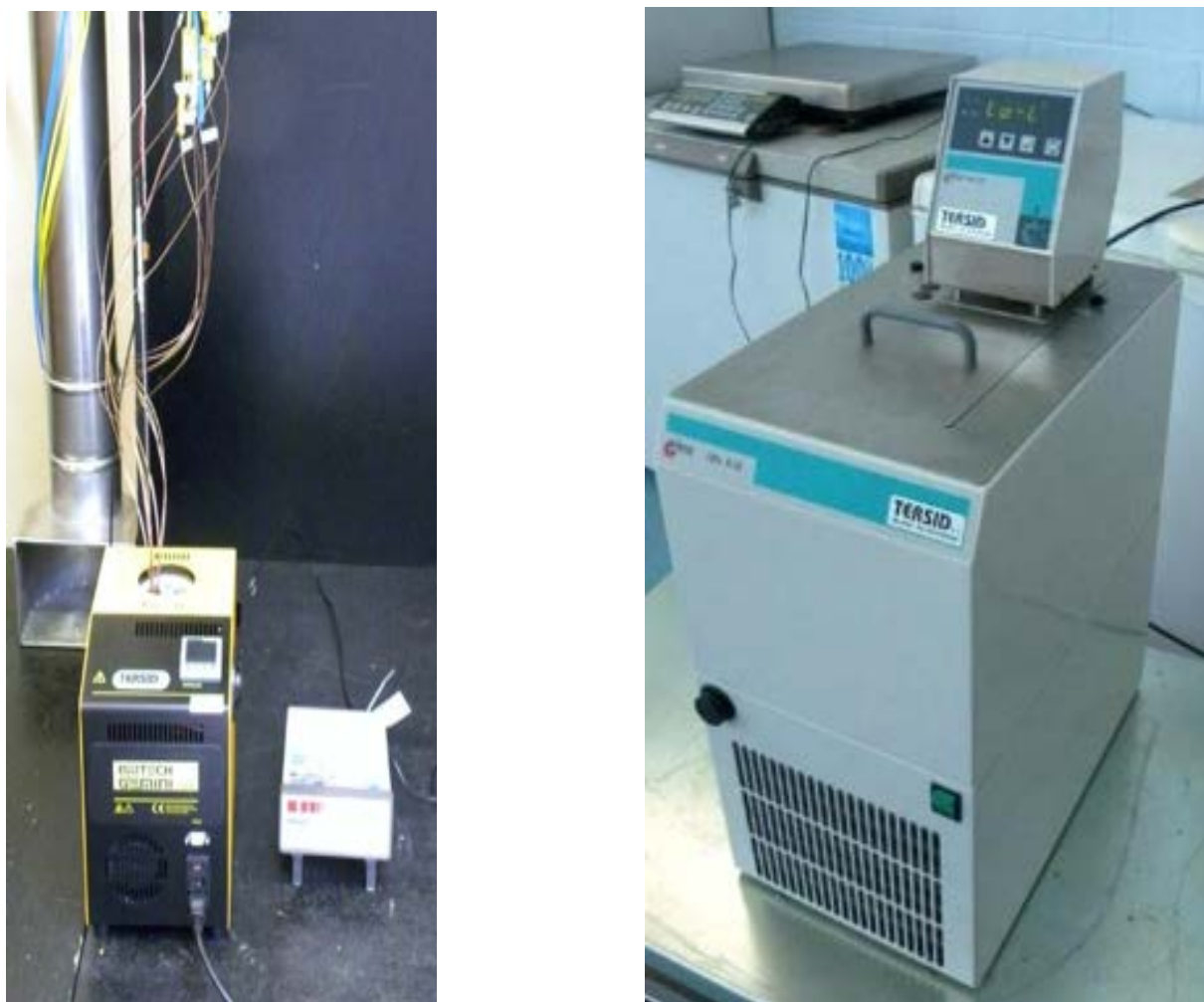
Figura 10: calibrazione di termoresistenze e termocoppie. Sinistra: forno termostatico. Destra: bagno termostatico.
