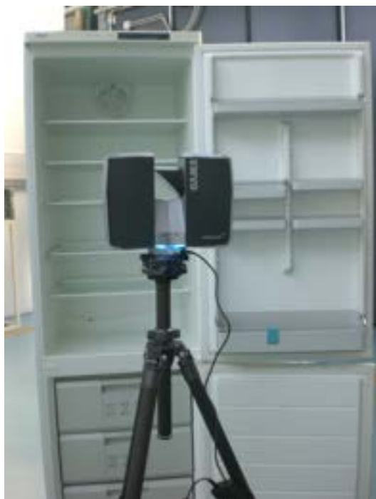
Figura 9: Laser scanner posizionato per misura volume
