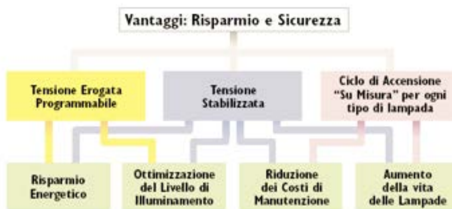
Fig. 2.3: vantaggi della regolazione del flusso luminoso
