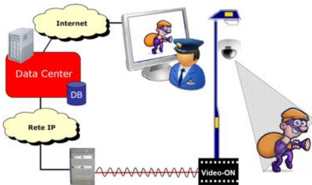
Fig. 2.13: principio di funzionamento del sistema di videosorveglianza
