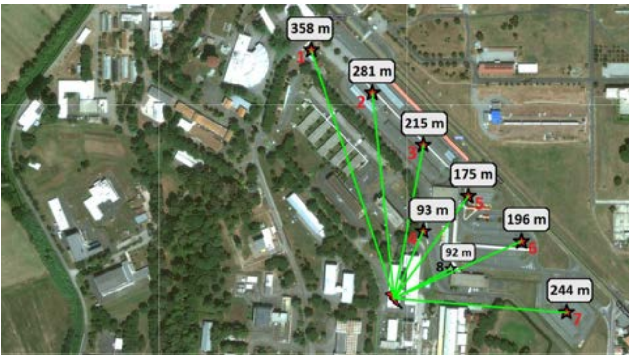
Fig. 5.2: Distanza delle torri dal quadro elettrico
