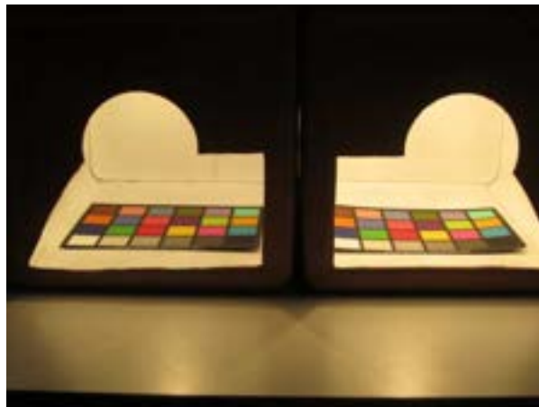
Figura 23: il setup sperimentale per il primo esperimento: Sono visibili i due light booth contenenti ciascuno un Macbeth Color Checker.
