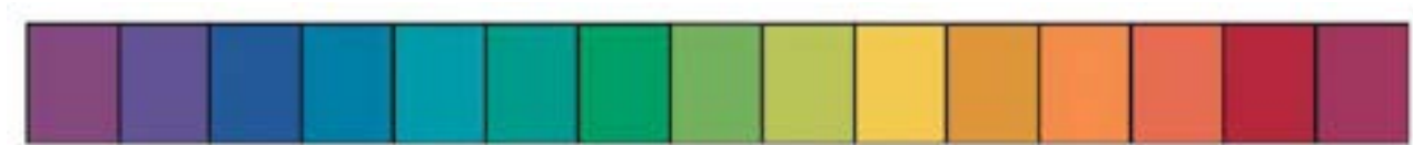
Figura 4: campioni usati nel calcolo del CQS, osservati sotto una illuminante D65. Immagine presa da [14].
