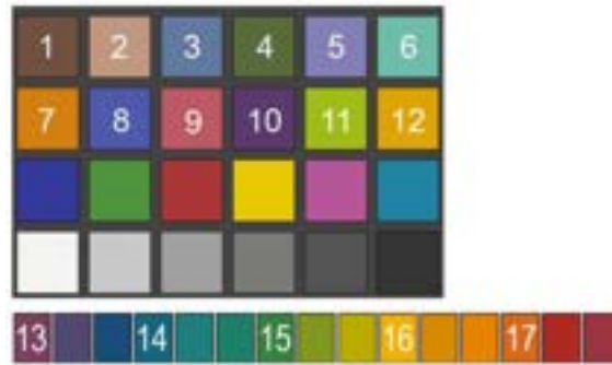
Figura 11: i 17 campioni usati per il calcolo del RCRI. Immagine presa da [25].
