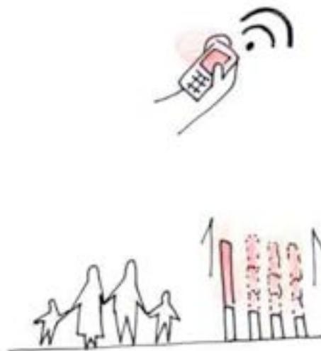
Figura 14: Esempio di sistema di illuminazione non tradizionale che segnala la presenza di inquinamento atmosferico eccessivo nel tratto stradale in cui si trovano
