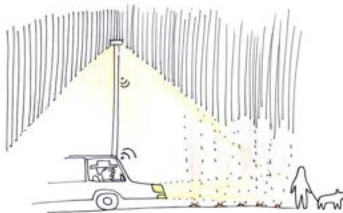
Figura 15: Esempio di sistema di illuminazione tradizionale e non tradizionale utile per garantire visibilità e sicurezza nella strada (incroci e attraversamenti pedonali) adeguando i livelli di illuminazione in base ad una serie di parametri
