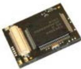
Eistec AB si occupa di mettere in comunicazione i prodotti e dispositivi grazie all'integrazione di un sistema internet (EIS) mediante il protocollo Bluetooth che può essere facilmente connesso ad infrastrutture esistenti con consumi molto ridotti. La piattaforma Mulle è in grado di far comunicare una serie di sensori attraverso TCP/IP, Bluetooth e il protocollo IEEE 802.15.4 (sia a 2.4 GHz sia a 868 MHz). La piattaforma Mulle ha dimensioni molto ridotte (24x26x5 mm).
