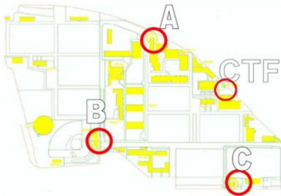
Fig.1.3 – Posizionamento delle cabina di trasformazione: consegna e trasformazione cabina A (2*630kVA), cabine secondarie di trasformazione B (2*630kVA), C (2*630kVA) e CTF (1*630kVA)
