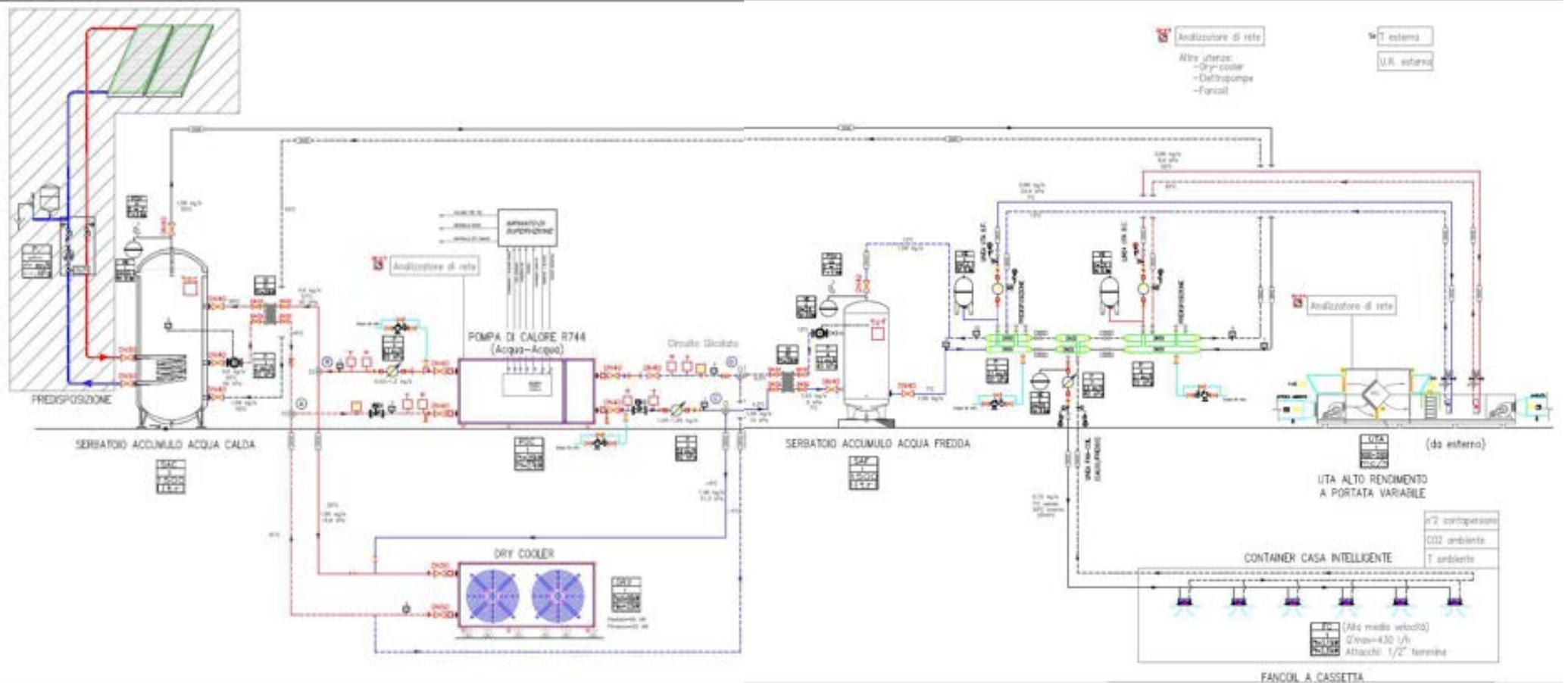
Figura 12: Schema funzionale dell'impianto sperimentale con pompa di calore a CO<sub>2</sub> installato presso il Centro Ricerche della Casaccia
