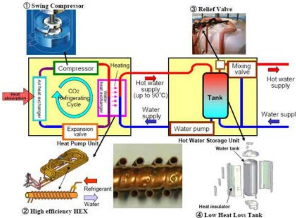
Figura 3: schema di funzionamento pompa di calore a CO<sub>2</sub> della Daikin
