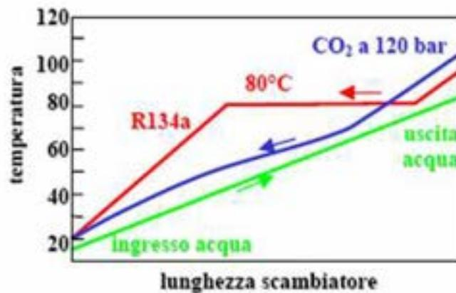
**Figura 1:** Riscaldamento dell'acqua sanitaria da 15 °C a 80 °C mediante una pompa di calore a CO<sub>2</sub>.
