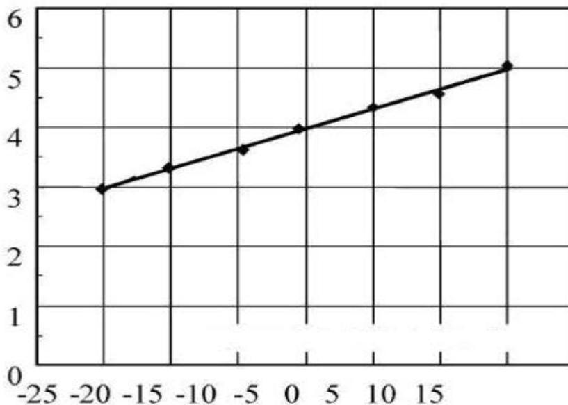
**Figura 5:** COP in funzione della temperatura di evaporazione per una temperatura di ingresso acqua di 10 °C
