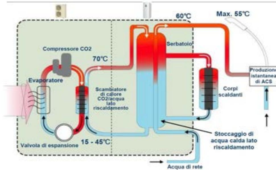
*Figura 2: schema di funzionamento pompa di calore a CO<sub>2</sub> della Sanyo*
