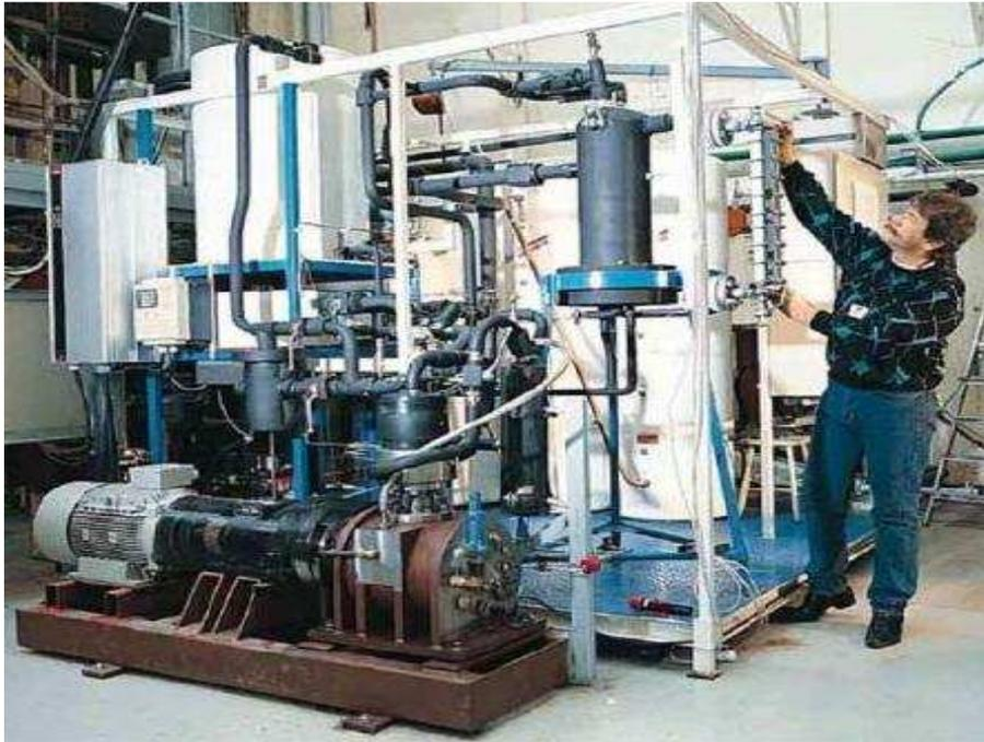
**Figura 4:** Prototipo di pompa di calore a CO<sub>2</sub> da 50 kW
