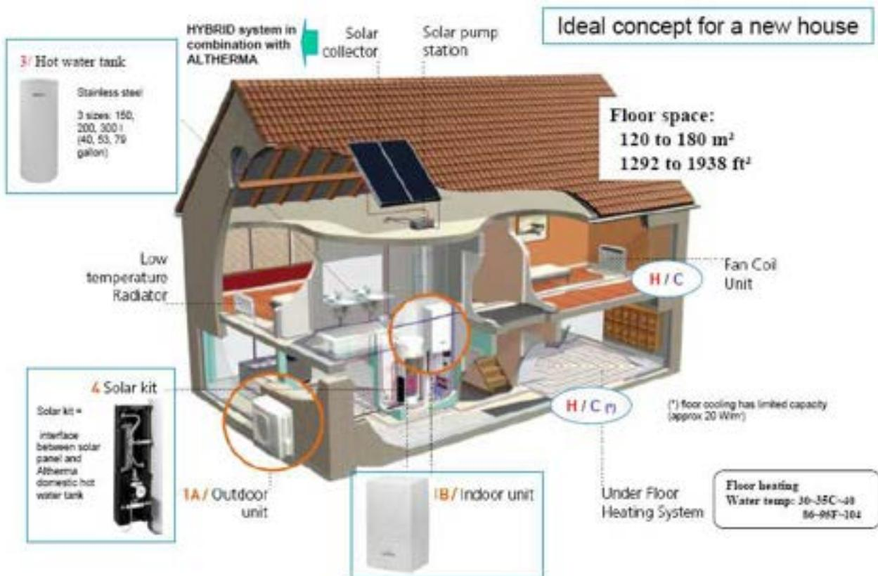
Figura 6: Pompa di calore a CO<sub>2</sub> alimentata da pannelli fotovoltaici in un'abitazione
