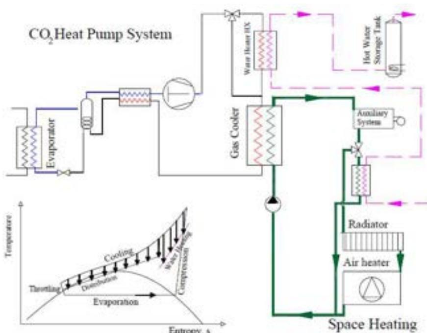
**Figura 7:** Schema d'impianto per produzione acqua calda e climatizzazione (Neksa, 1992)
