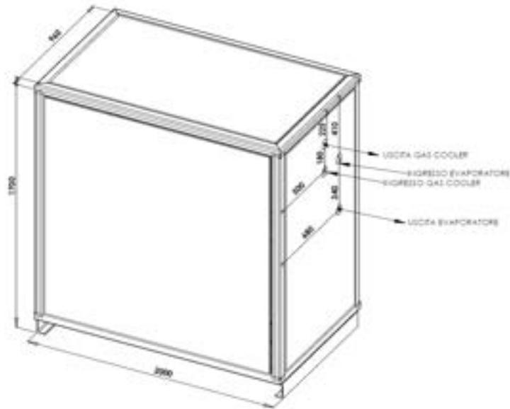
**Figura 14:** pompa di calore a CO<sub>2</sub> ENEX: principali dimensioni
