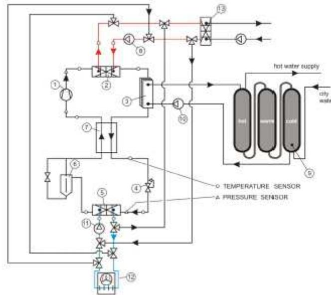
**Figura 9:** Schema di impianto pdc a CO<sub>2</sub> proposto da Brignoli et al. (2011) – conf. invernale
