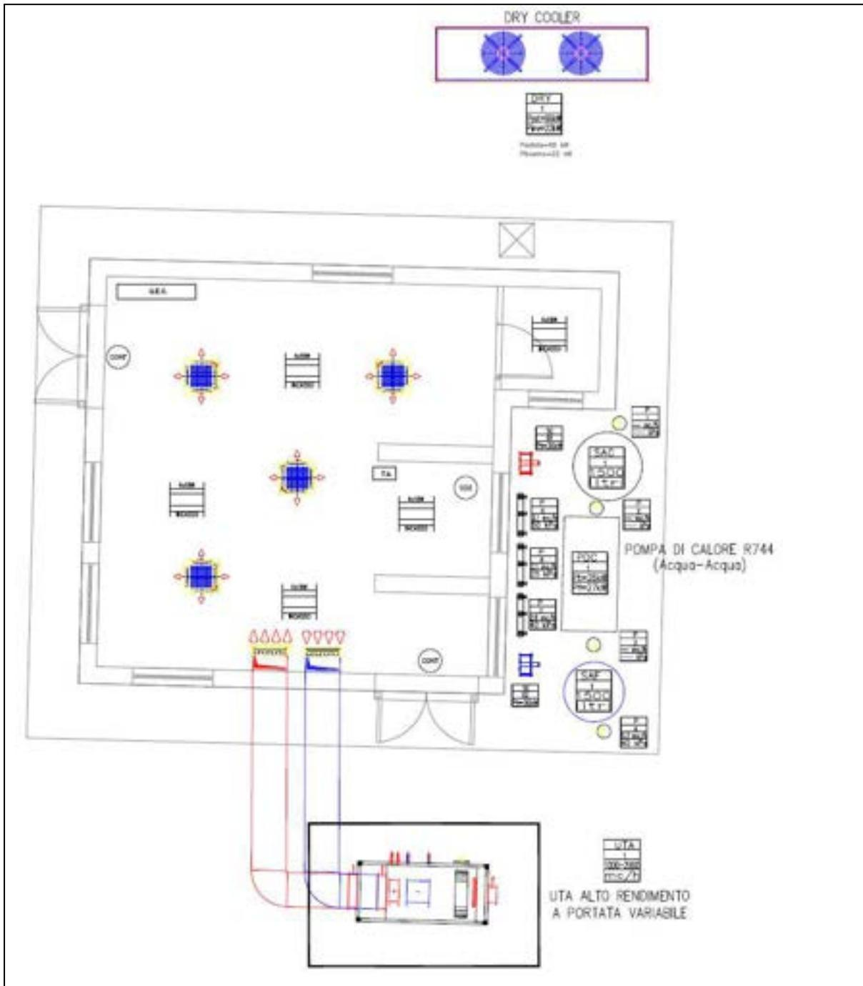
Fig. 23 – Locale Container- disposizione componenti
