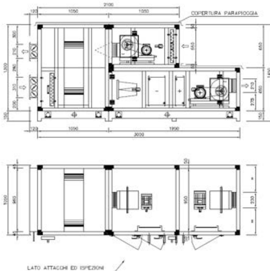
**Figura 16:** vista in sezione e in pianta della UTA marca LORAN installata
