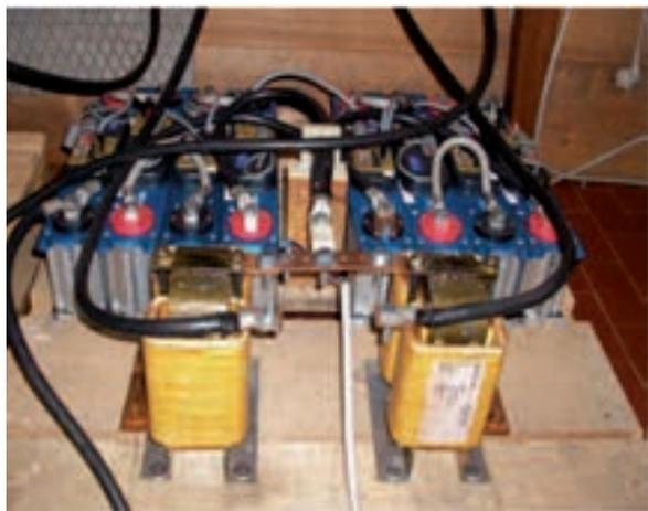
*Accumulo misto batterie + supercondensatori sviluppato in ENEA*
