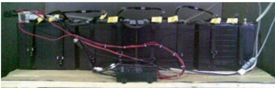
*Sistema d’accumulo Li-Io 200Ah/48 V realizzato e testato in ENEA*
