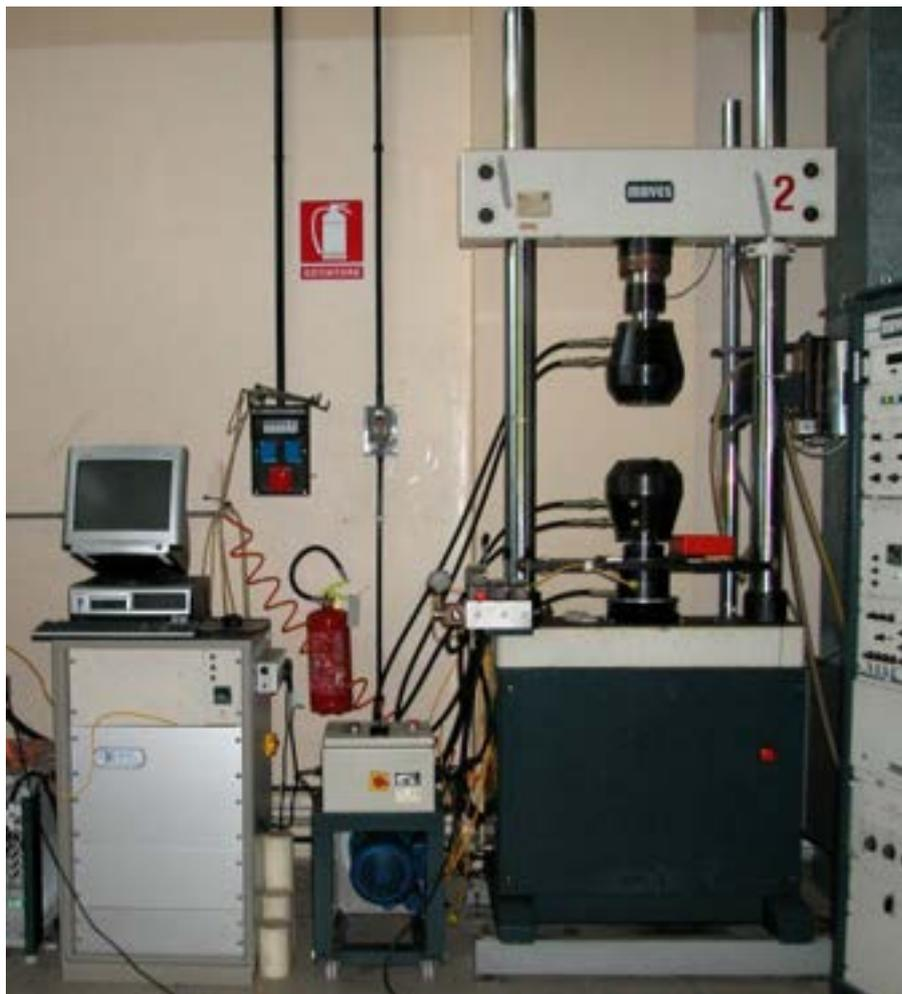
**Figura 1: Vista di insieme del telaio di prova (capacità  $\pm 100$  kN). La macchina è rappresentata munita di sistema di afferraggio a mordacchie idrauliche**
