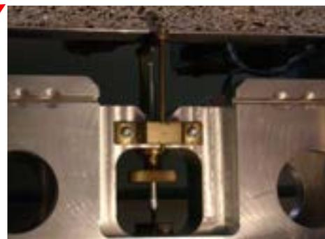
**Figura 4: Apparecchiatura per prove a flessione in fase di collaudo.**
