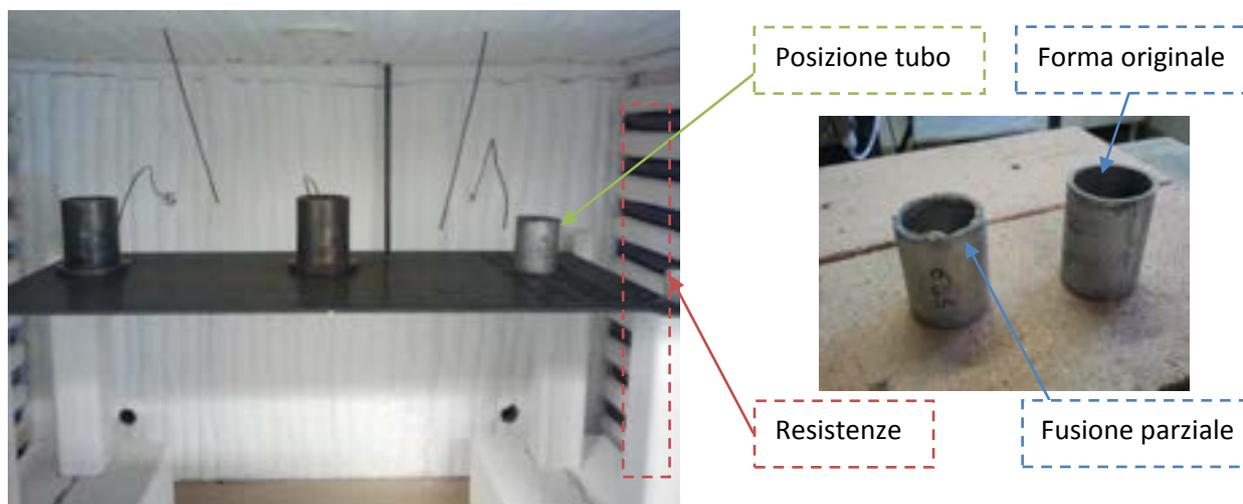
**Figura 51: Test di stabilità del profilato estruso.**
