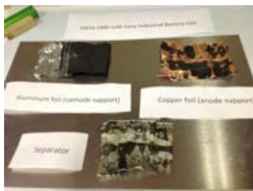
Figura 5. Parte dei componenti della batteria Sony 18650 separati.
