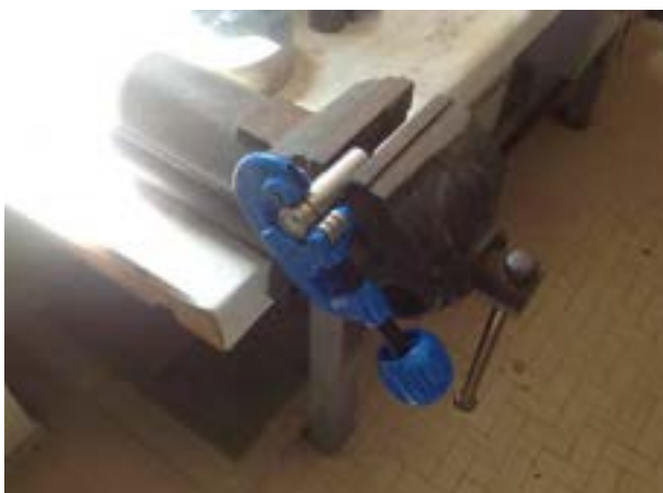
Figura 3. Apertura della batteria 18650 Sony.
