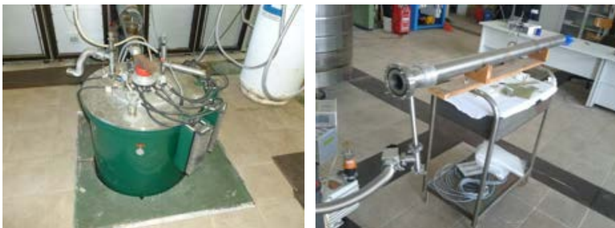
Figura 9. A sinistra: criostato equipaggiato con magnete da 14 T. A destra: contro criostato per misure in azoto liquido.
