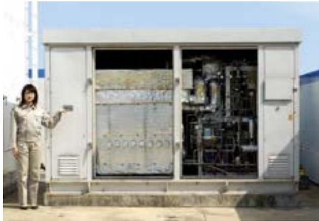
**Figura 2. Un reformer a membrana da 40 Nm<sup>3</sup>/h.**
