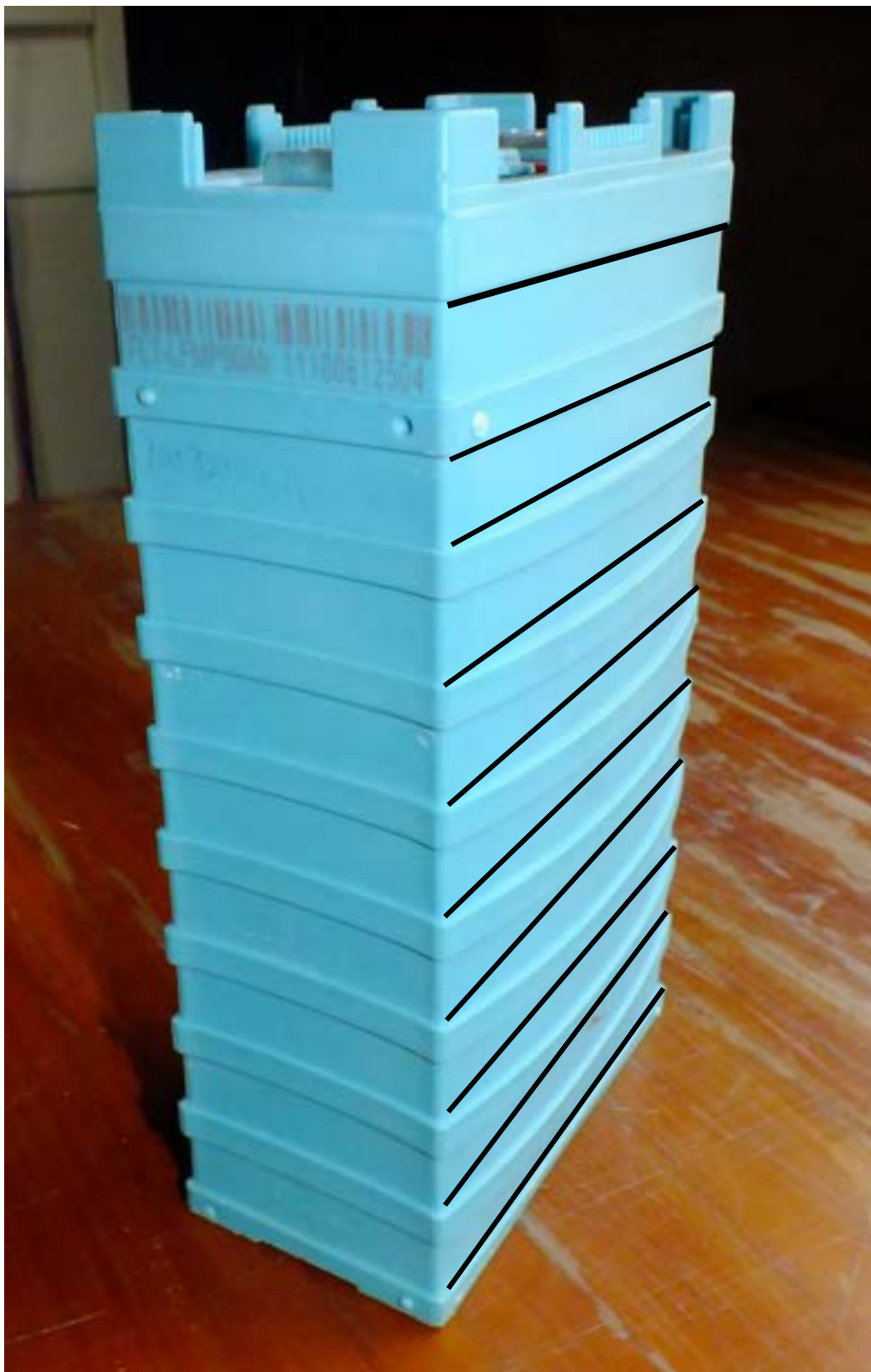
Figura 14. Deformazione del contenitore della cella in prova
