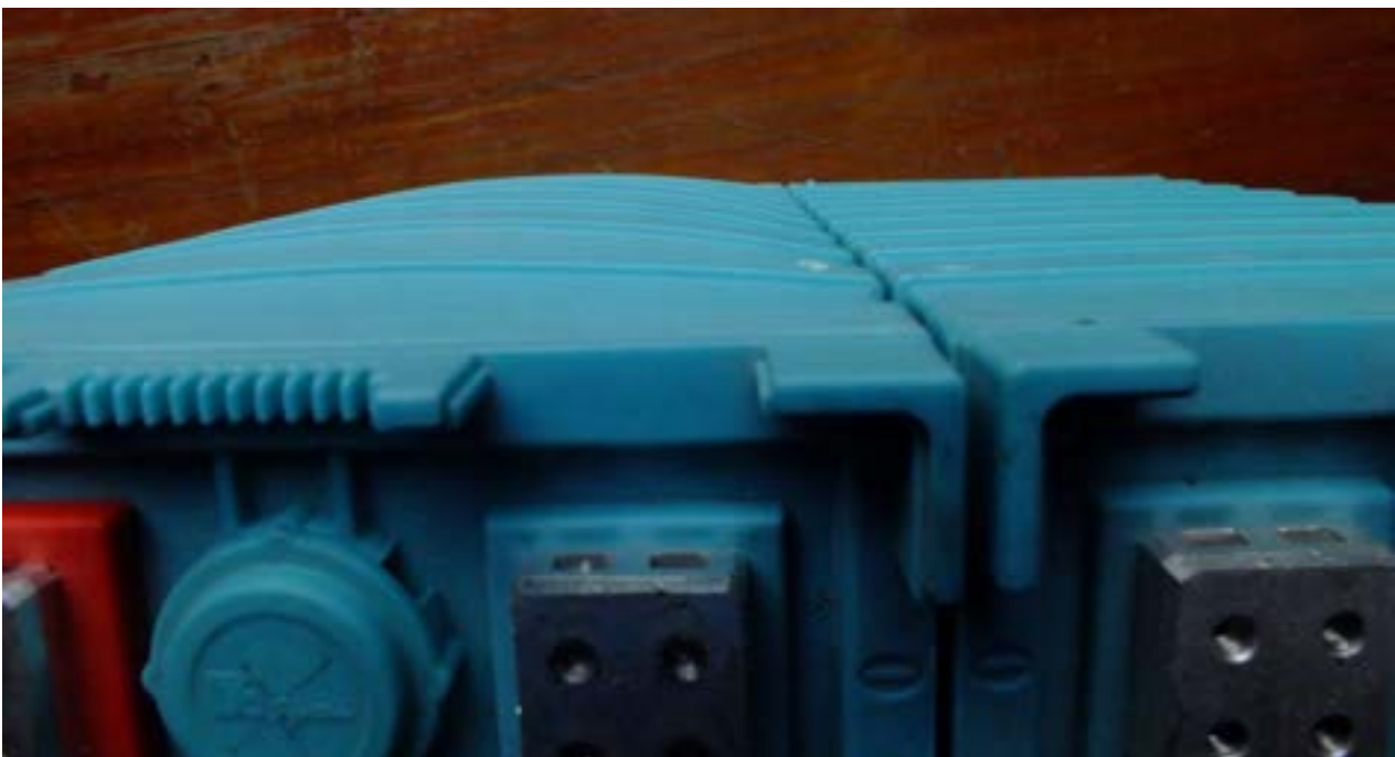
Figura 13. Deformazione del contenitore della cella in prova comparato con uno di riferimento
