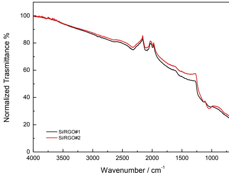
**Figura 2. Analisi FTIR delle due miscele di nanocomposito Si/RGO#1 e Si/RGO#2**
