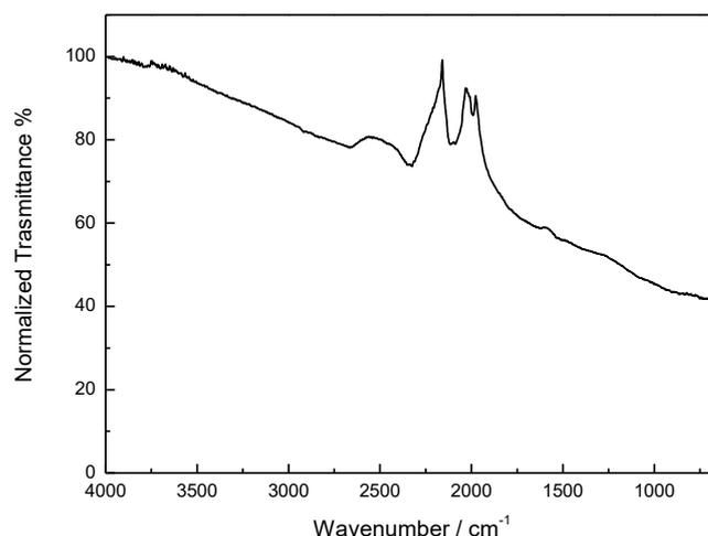
Figura 7. Analisi FTIR del nanocomposito  $\text{SnO}_x$ /RGO
