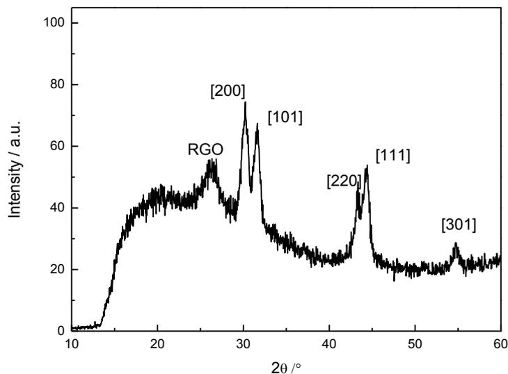
**Figura 8. Pattern di diffrazione del nanocomposito SnO<sub>2</sub>/RGO**
