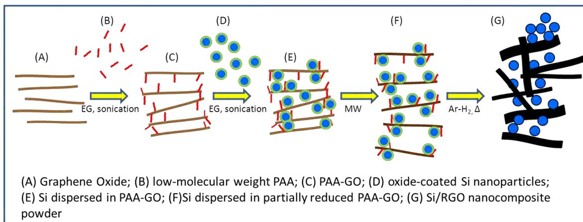
Figura 1. Schema di sintesi del nanocomposito Si/RGO
