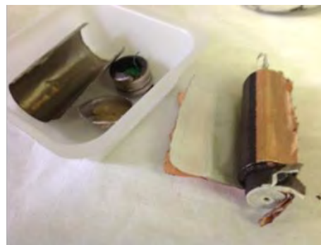
Figura 7. Le foto mostrano la sequenza delle operazioni di laboratorio per l'apertura di una batteria commerciali tipo 18650
