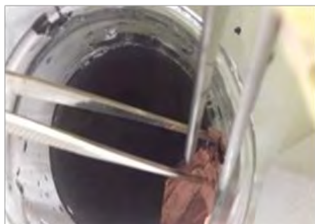
Figura 15. Sequenza di foto ottenute su un nastro anodico sonicato in acqua: operazione di separazione del materiale attivo dal collettore metallico Cu
