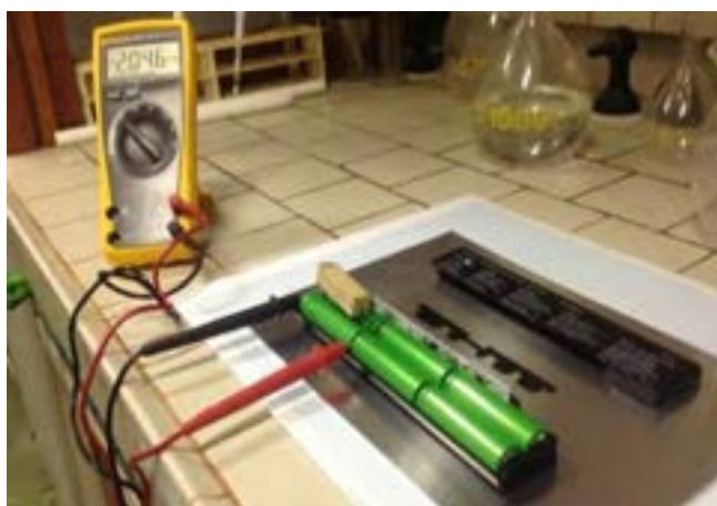
Figura 5. Scarica elettrochimica completa di una batteria commerciale Sony 18650
