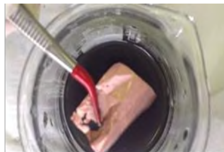
Figura 14. Sequenza di foto ottenute su un nastro catodico sonicato in acqua: operazione di separazione del materiale attivo dal collettore metallico Al
