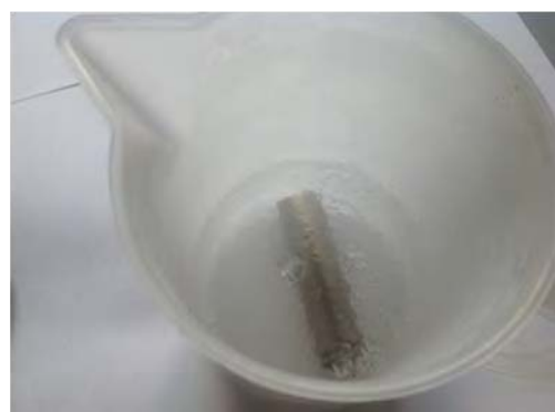
Figura 6. Foto di una batteria commerciale utilizzata: A) separazione dell' involucro di plastica . B) condizionamento in azoto liquido
