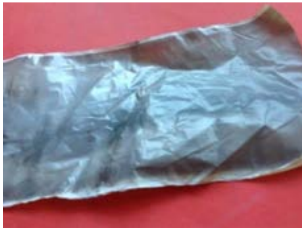
Figura 13. Foto del separatore recuperato dopo il trattamento in acqua distillata
