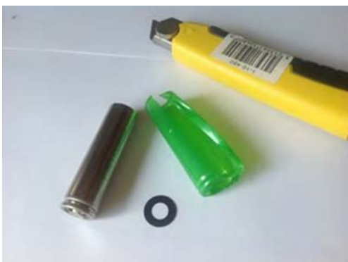
Figura 6. Foto di una batteria commerciale utilizzata: A) separazione dell' involucro di plastica . B) condizionamento in azoto liquido
