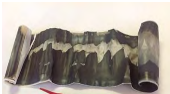
Figura 11. Foto del separatore polimerico ricavato dalla batteria commerciale Sony 18650
