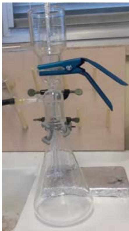
Figura 8. Dispositivo di filtrazione a pressione ridotta
