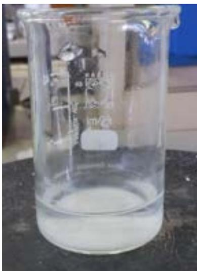
**Figura 9. Soluzione proveniente dalla precipitazione di  $\text{Li}_3\text{PO}_4$  con presenza di corpo di fondo in formazione**
