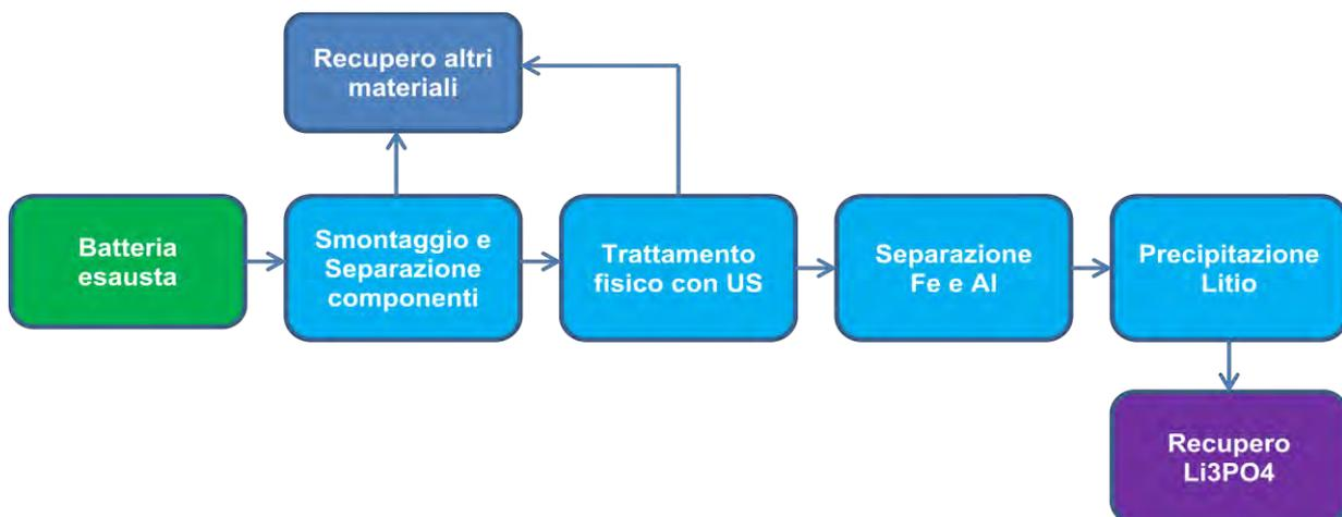
**Figura 5. Schema del processo di recupero del litio preceduto dal metodo 1 di pretrattamento della batteria Li-ione**
