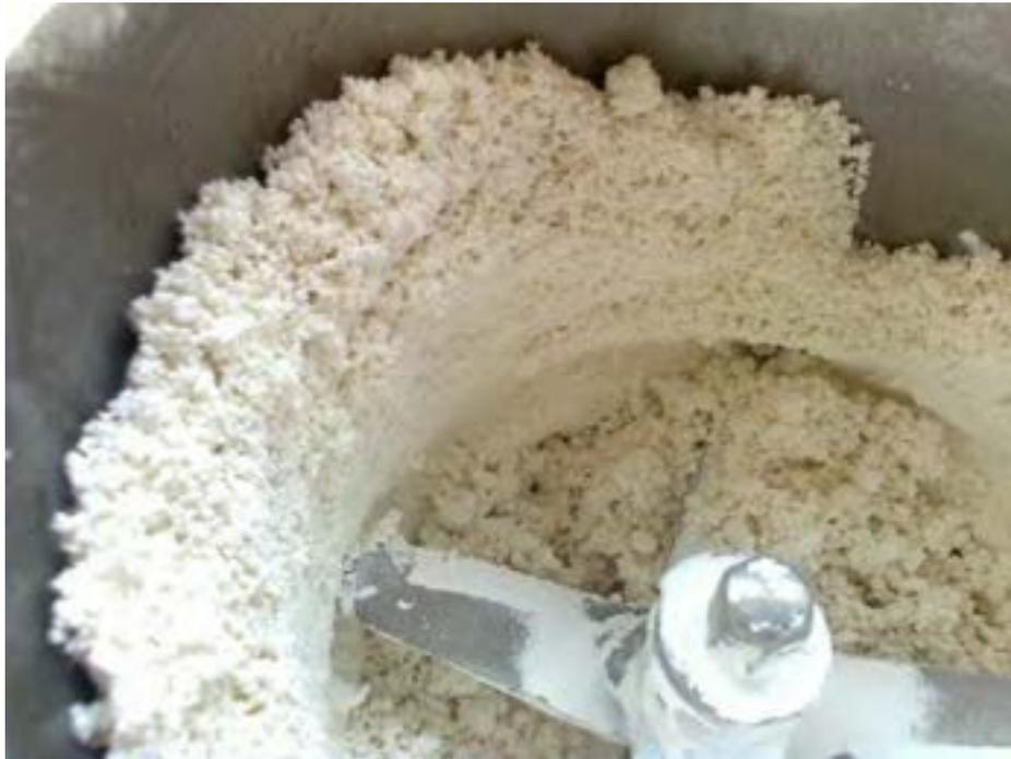
**Figura 16. Granulazione della polvere dopo agglomerazione in turbomiscelatore**
