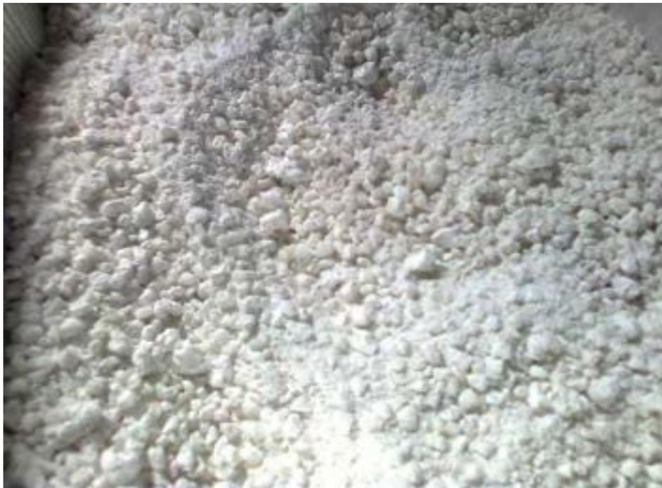
**Figura 17. Granulato essiccato, prima del passaggio in estrusore**
