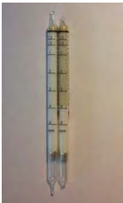
Figura 9. Test con tubi Drager per la determinazione del contenuto di H 2 S nella miscela CH 4 /CO 2 60/40. Il valore ottenuto di 4 ppm su 2 mL di campione equivalenti ad una concentrazione di 2000 ppm
