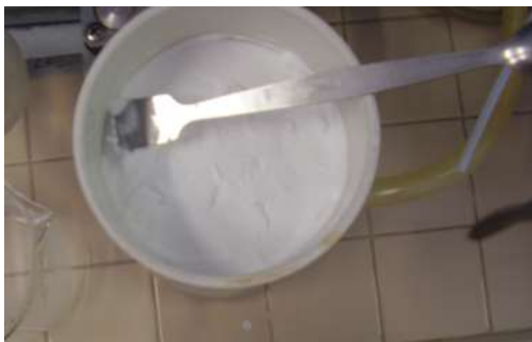
Figura 4. Idrotalcite durante la fase di filtrazione
