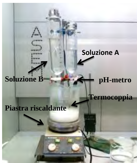
Figura 2. Sintesi dell'idrotalcite a pH costante
