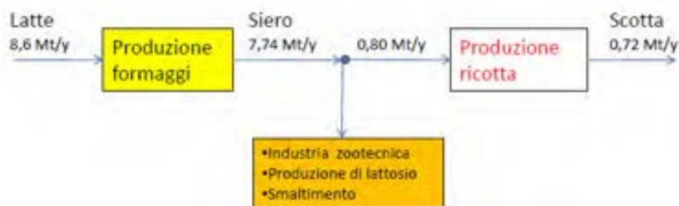
Figura 1. Diagram block del processo dell'industria casearia in Italia
