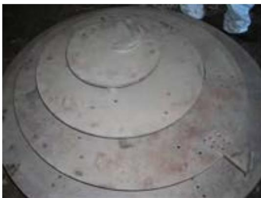
**Figura 2.2. Parte esterna della griglia del gassificatore dimostrativo**
