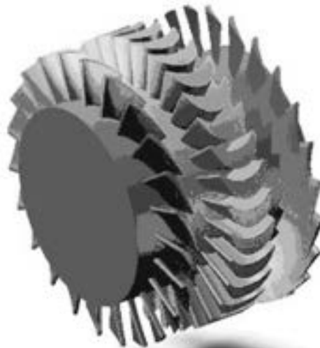
Fig. 24 - Turbina ad azione autorettificante
