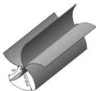
Fig. 28 - Esempio di rotore Savonius a 5 pale per dispositivo OWC
