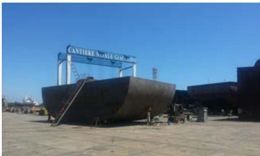
**Figura 8. Il sistema ISWEC 100 kW: realizzazione dello scafo**
