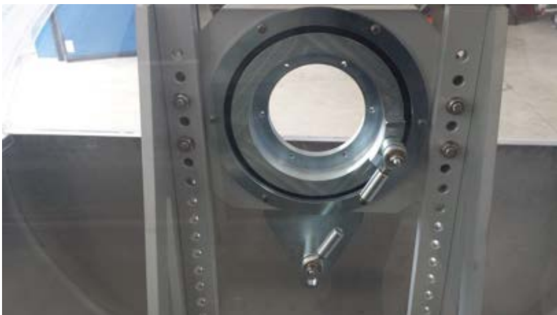
Figura 6 - Cuscinetto con attacchi della cella di carico
