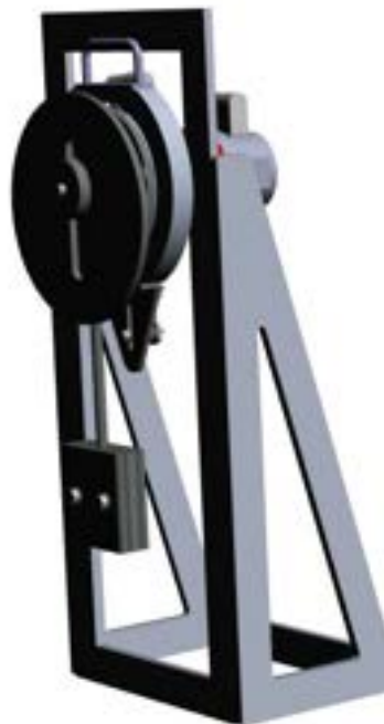
Figura 3- Modello 3D del meccanismo oscillante
