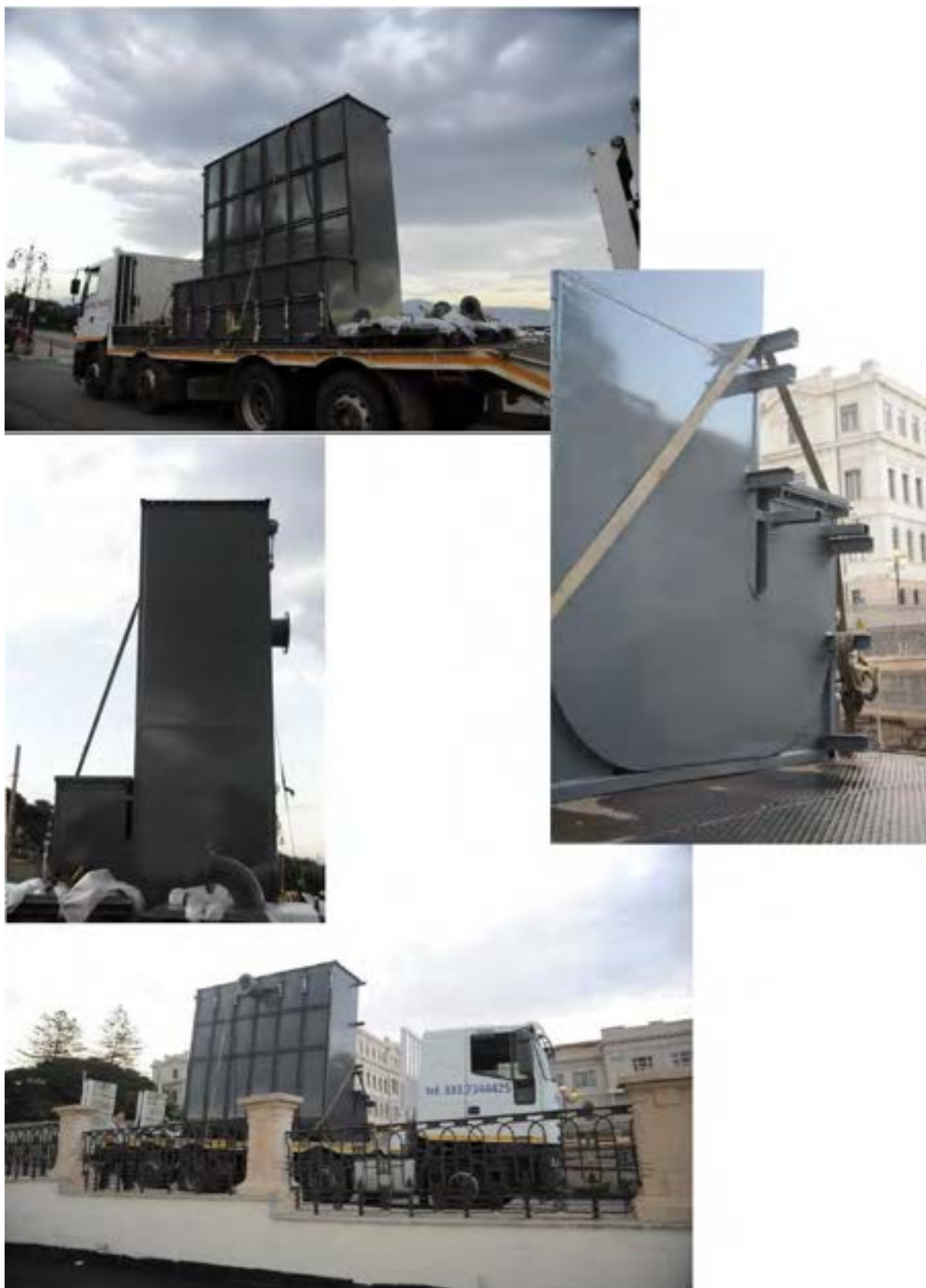
Figura 13. Trasporto del cassone in acciaio dall'officina meccanica al Natural Ocean Engineering Laboratory. Particolare dell'imbocco sommerso del condotto verticale (a destra).
