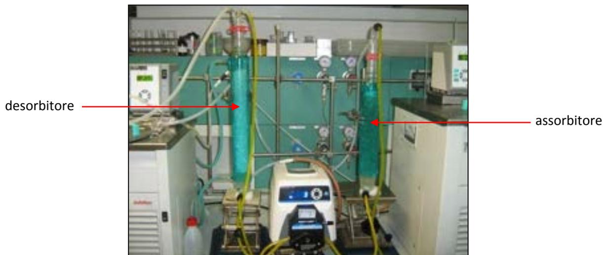
**Figura 9- Sistema a ciclo chiuso per l' assorbimento e il desorbimento di CO<sub>2</sub> con le soluzioni non acquose delle ammine. La temperatura nei due cilindri è controllata con circolazione di glicol etilenico termostattizzato.**
