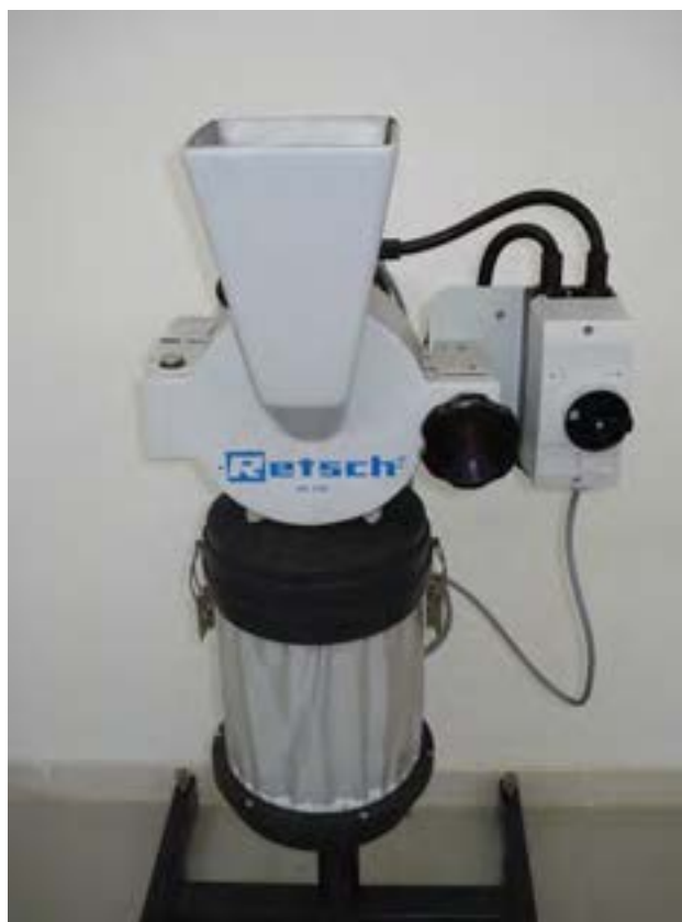
Figura 2. Mulino a croce SK100 Retsch
