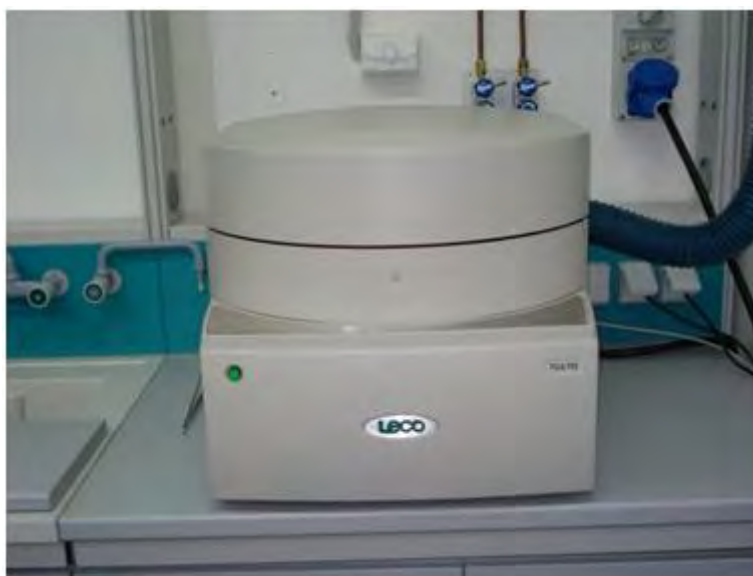
Figura 5. Analizzatore termo gravimetrico LECO TGA-701
