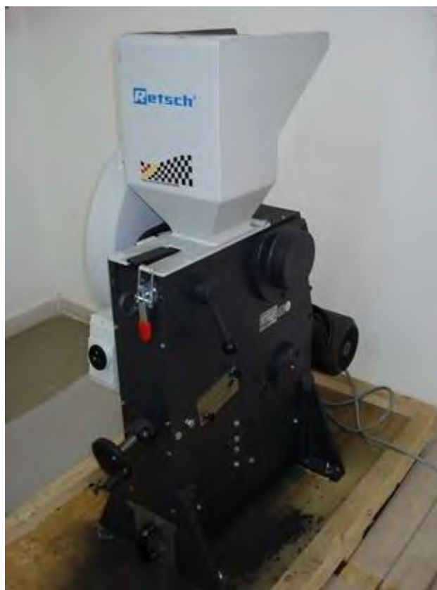
Figura 1. Frantoio a mascelle BB200 Retsch
