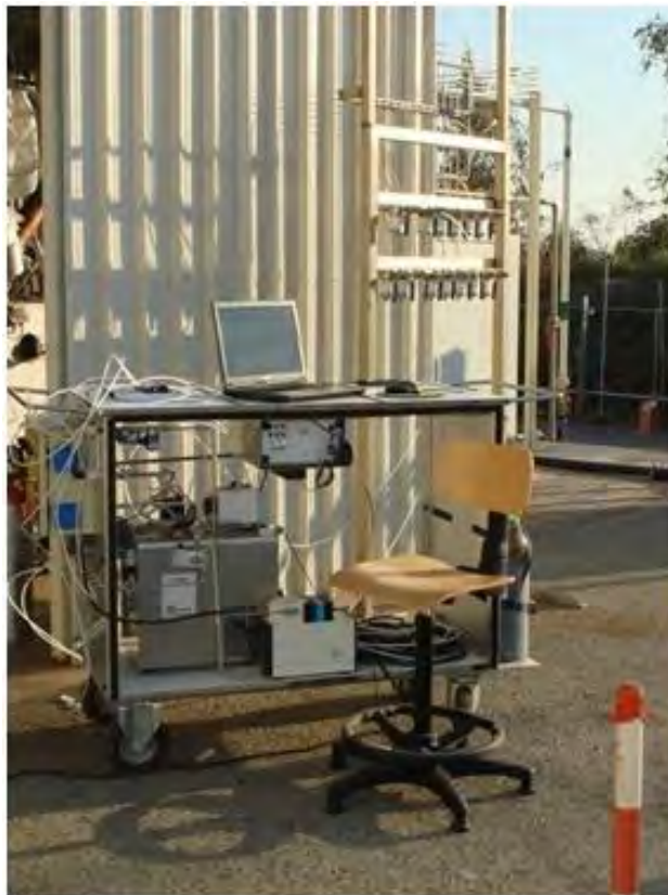
Figura 9. Sistema di campionamento e analisi gas tramite micro-GC
