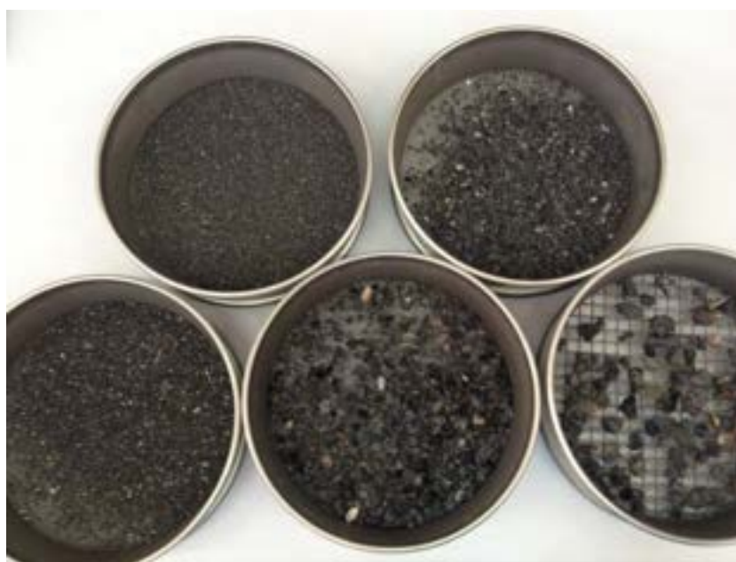
Figura 8. Separazione granulometrica scarico gassificatore
