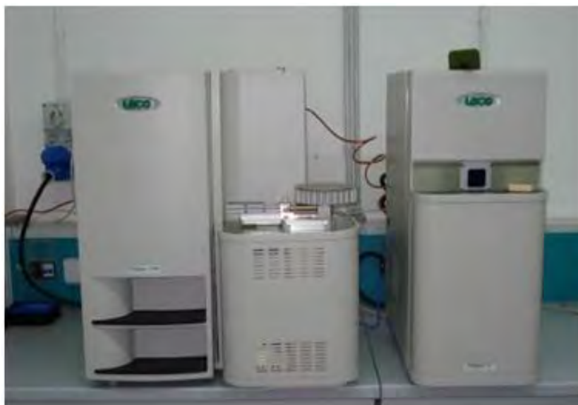
Figura 4. Analizzatore elementare LECO ruspec CHN/S
