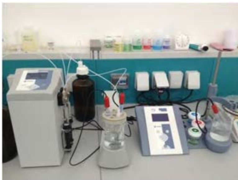
Figura 14. Sistemi di analisi per la titolazione di soluzioni acquose di ammine
