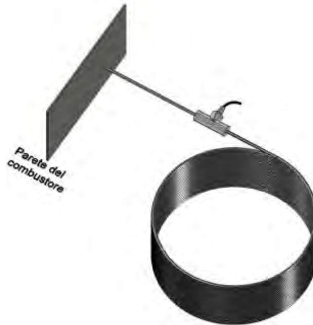
**Figura 2-16: Sketch di un set-up con guida d'onda.**
