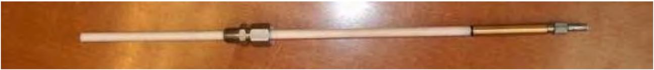
**Figura 2-14: Testa ottica con fibra di zaffiro ( $\Phi = 2 \text{ mm}$ ) in un tubo protettivo di allumina ( $\Phi \approx 5 \text{ mm}$ ).**
