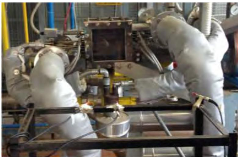
**Figura 2-12: Posizionamento dei microfoni all'esterno del TVC.**
