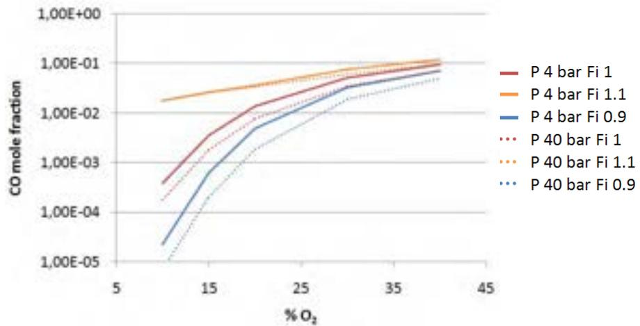
Figura 4.3. Frazione molare di CO all'equilibrio per la miscela CH<sub>4</sub>/CO<sub>2</sub>/O<sub>2</sub> vs % O<sub>2</sub> nel comburente. T<sub>in</sub>=870 K.
