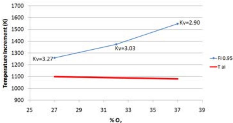
Figura 5.8. Massimo incremento di temperatura vs % O<sub>2</sub> nel comburente. Tin=470 K. Regime premiscelato.
