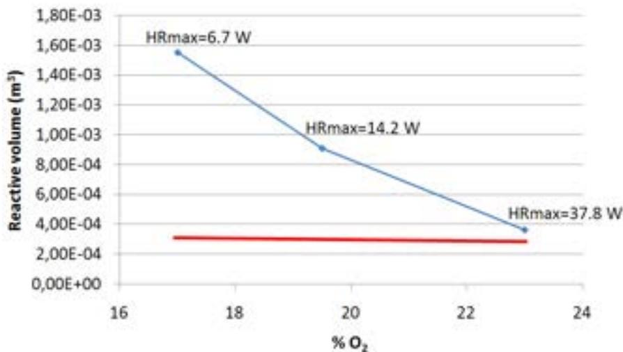
Figura 6.4. Volume reattivo vs % O<sub>2</sub> nel comburente. Regime diffusivo.
