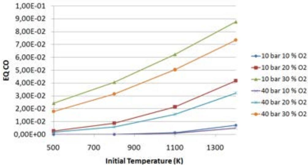
Figura 4.2. Frazione molare di CO di equilibrio per la miscela CH<sub>4</sub>/CO<sub>2</sub>/O<sub>2</sub> vs temperatura iniziale.
