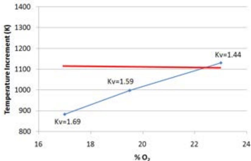
Figura 6.3. Massimo incremento di temperatura vs % O<sub>2</sub> nel comburente. Tin=870 K. Regime diffusivo.
