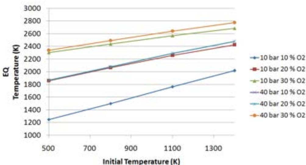
Figura 4.1. Temperatura di equilibrio per la miscela  $\text{CH}_4/\text{CO}_2/\text{O}_2$  vs temperatura iniziale.
