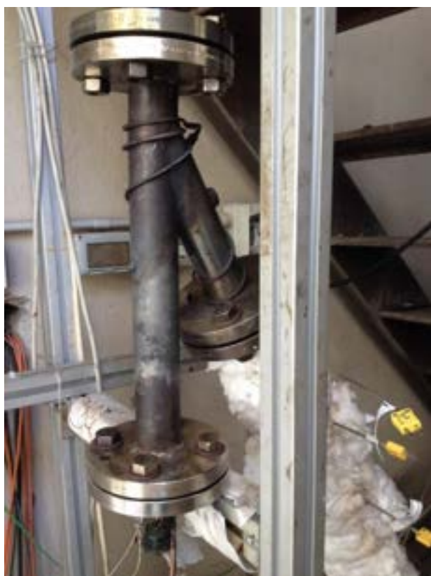
Figura 7: Reattore di gassificazione in configurazione up-draft.
