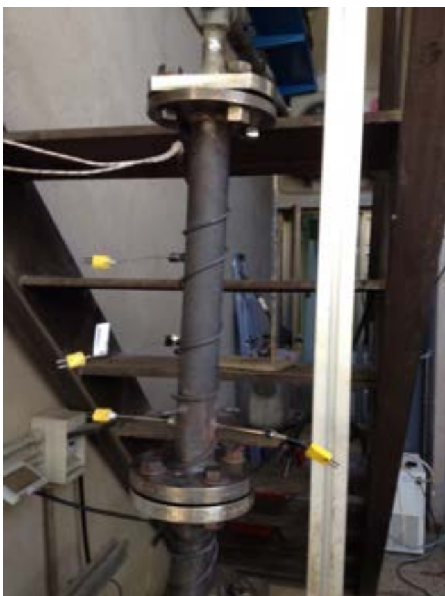
Figura 8: Reattore di reforming.
