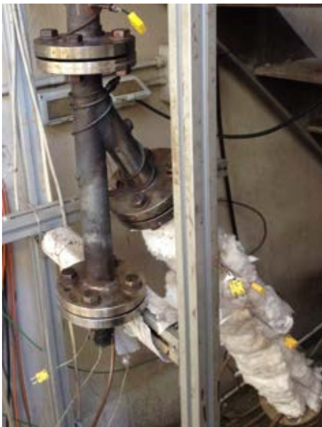
Figura 6: Particolare: reattore di pirolisi e gassificazione.
