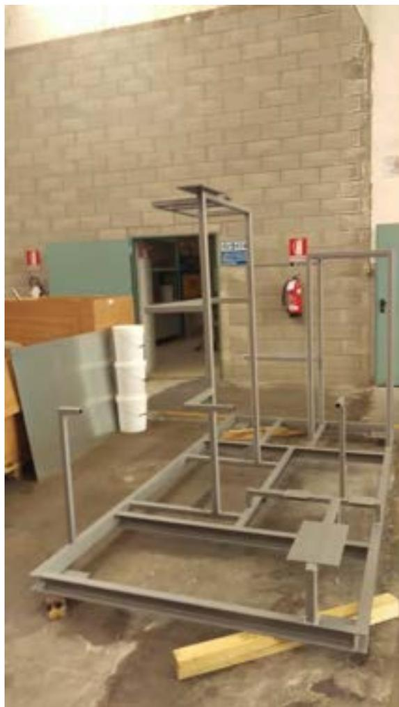
Figura 6-1 Strutture metalliche dello skid
