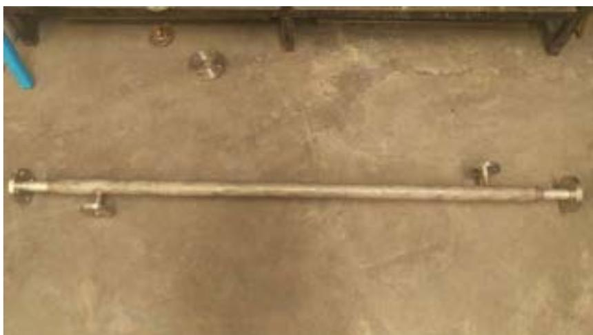
Figura 6-2 Particolare dello scambiatore rigenerativo a doppio tubo della sezione di disidratazione
