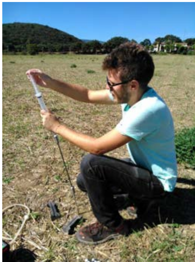
Figura 1. Campionamento di gas del suolo; la sonda presenta nella parte terminale fori per l'entrata dei gas e alla sommità un sistema di prelievo (vedi figura) fornito di setto impermeabile ai gas. Il gas, dopo lavaggio, viene estratto mediante una siringa di 50 cc.
