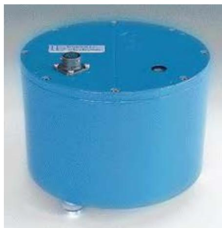
**Figura 3.2** Immagini dei sensori sismici: a sinistra il sensore Lennartz LE3D/5s; a destra il sensore Nanometrics Trillium Compact 120s (le immagini non sono in scala relativa tra i due oggetti, il LE3D/5s è più grande del Nanometrics).
