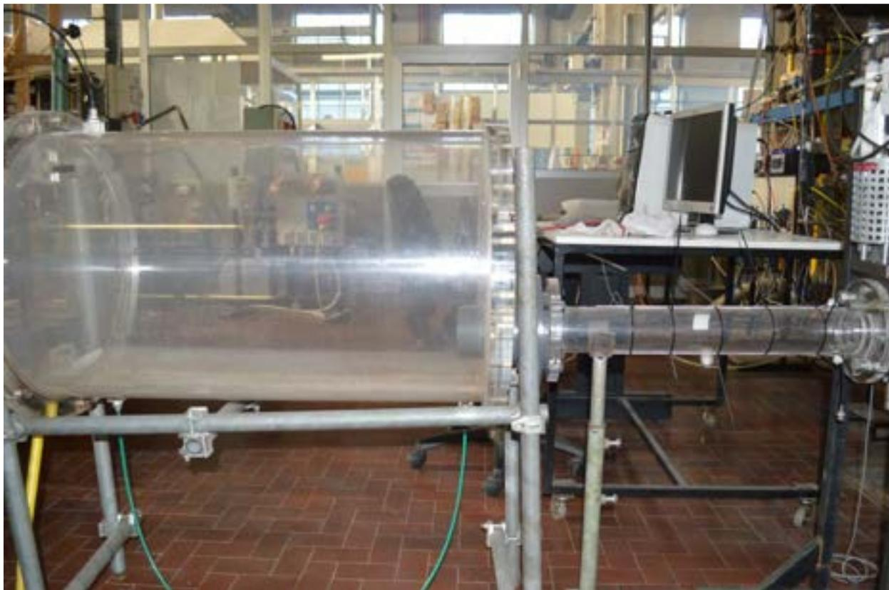
Fig. 7 Sistema di scarico del deflusso a valle del tubo di Venturi (configurazione orizzontale).
