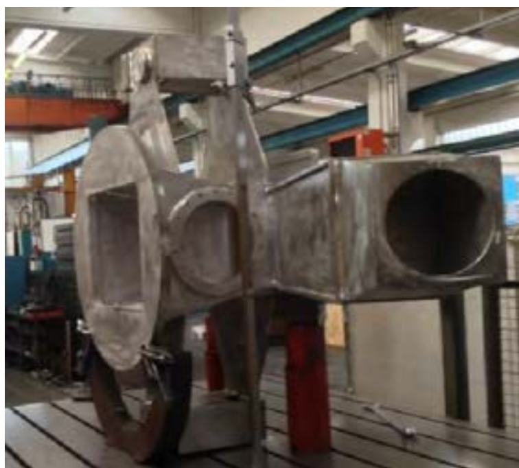
Fig. 15 TA body machining
