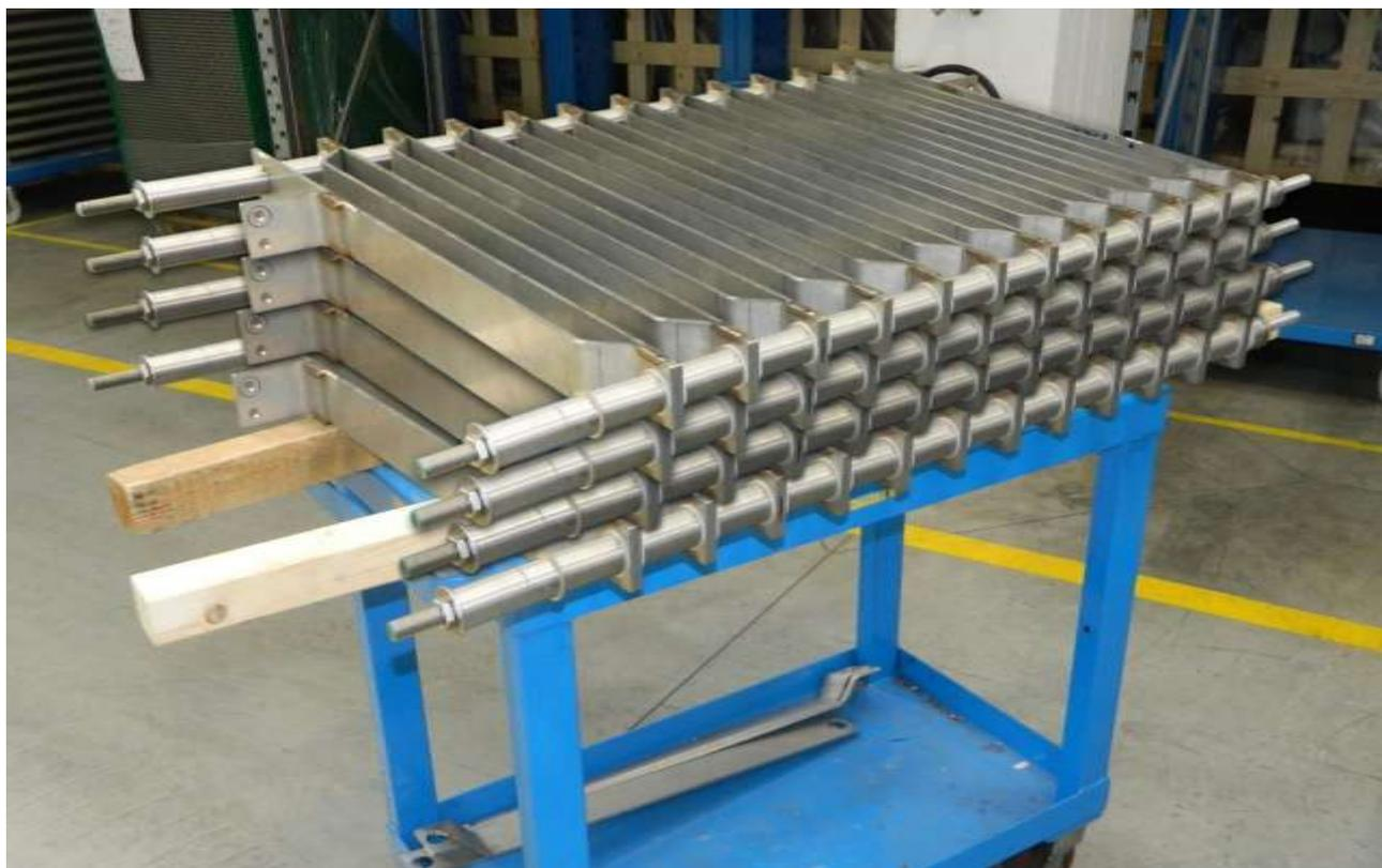
Figura 20. Pacchi resistivi di R2 nella configurazione finale.
