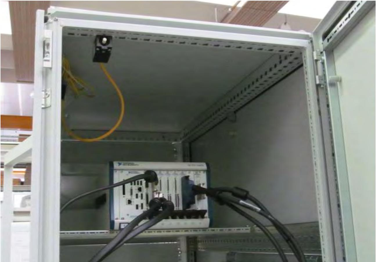
**Figura 21.** Dettaglio dell'armadio LCC in cui è visibile il sistema PXI che costituisce il cuore del controllo degli SNU. Attualmente il controllore LCC è dedicato solo al prototipo. Dopo la costruzione degli ulteriori 3 SNU, questo sistema sarà aggiornato per controllare tutti e 4 gli SNU.
