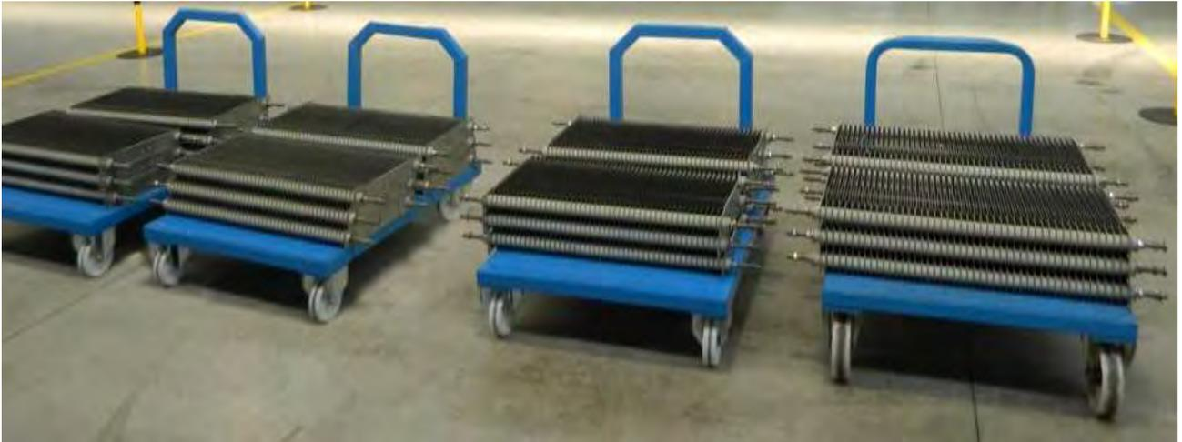
Figura 17. Pacchi resistivi del banco R1 prima dell'assemblaggio.
