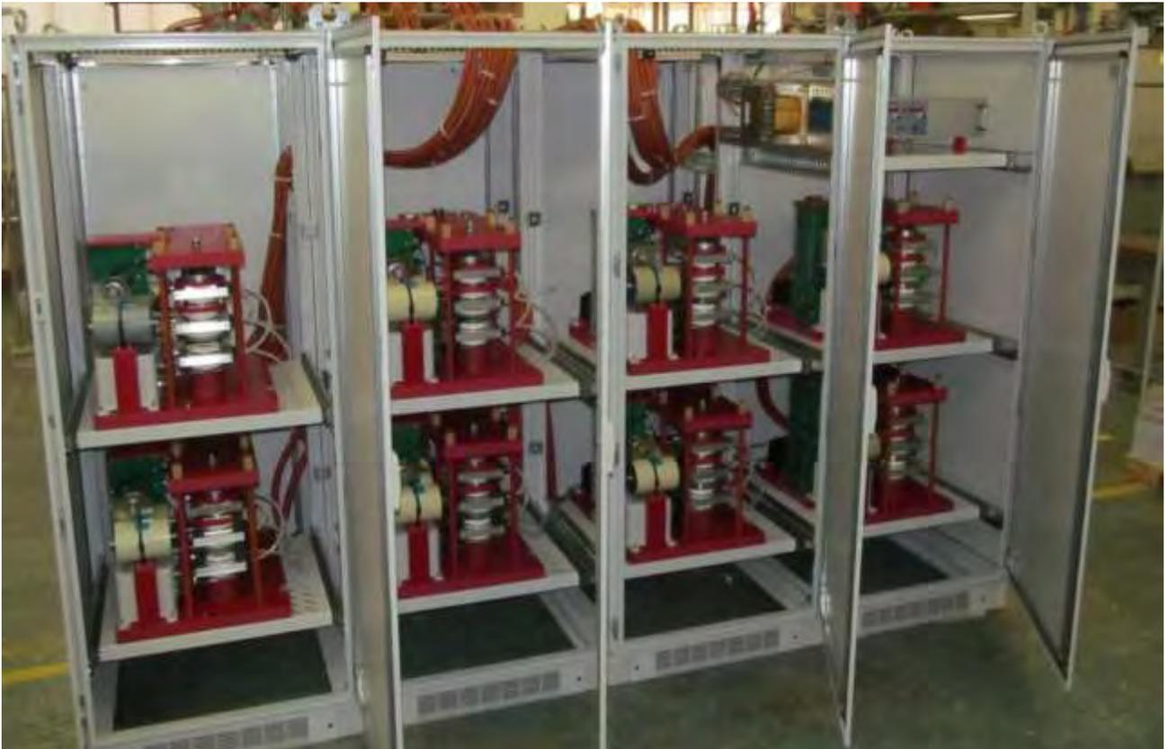
Figura 13. Armadio SCB, dal lato "stack" accessibile tramite portelle. Sono visibili gli otto moduli in parallelo.
