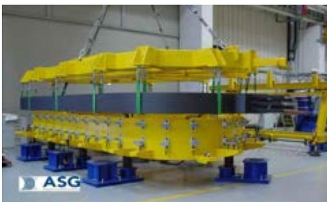
**Figura 24 Inserimento del primo avvolgimento nell'attrezzatura di inserimento**
