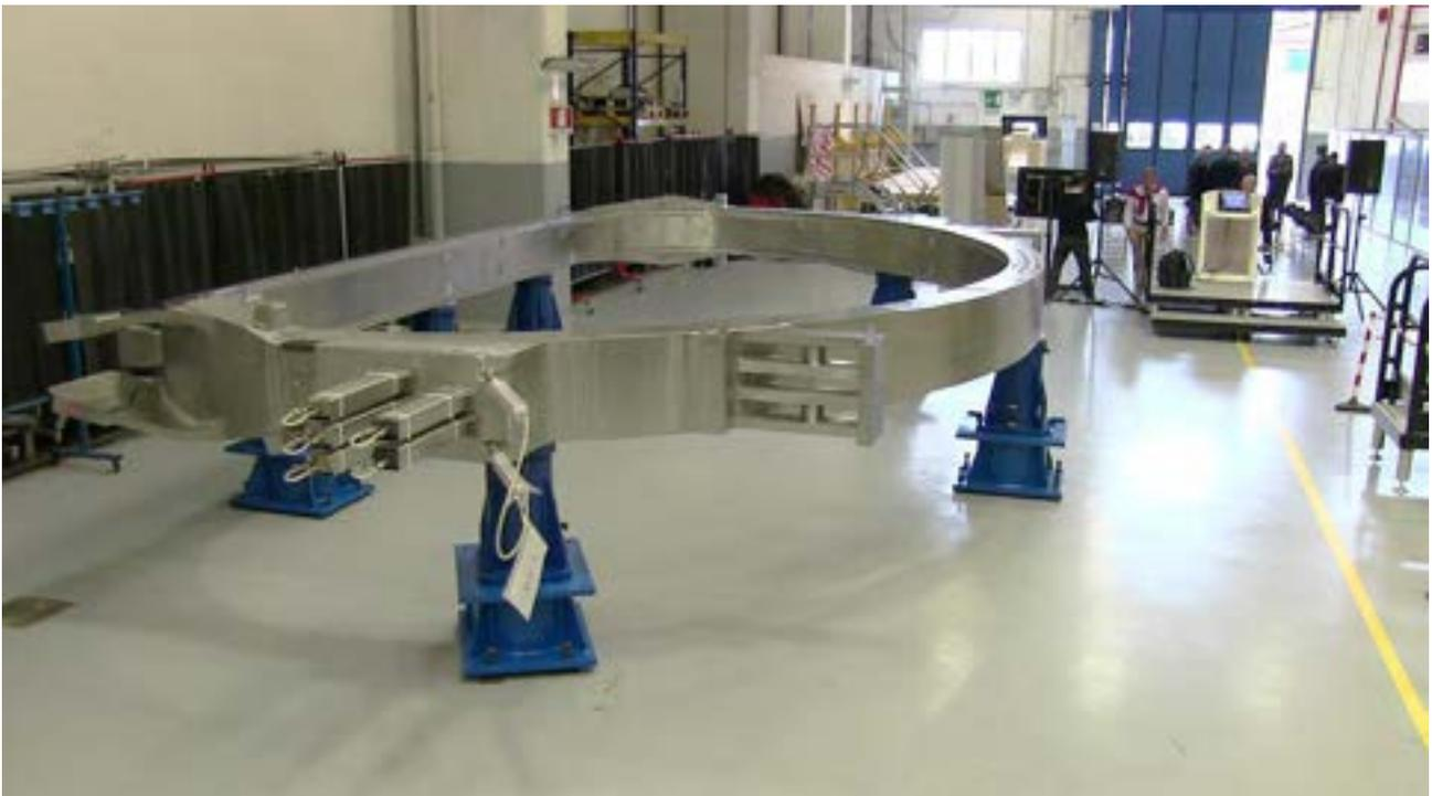
**Figura 29** Preparazione modulo per impregnazione finale
